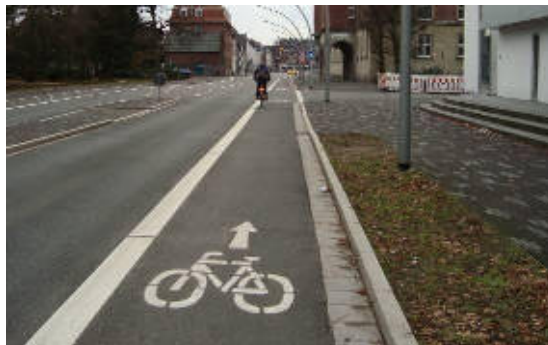
Abb. 151: Radverkehrsführung auf der Fahrbahn: Radfahrstreifen
