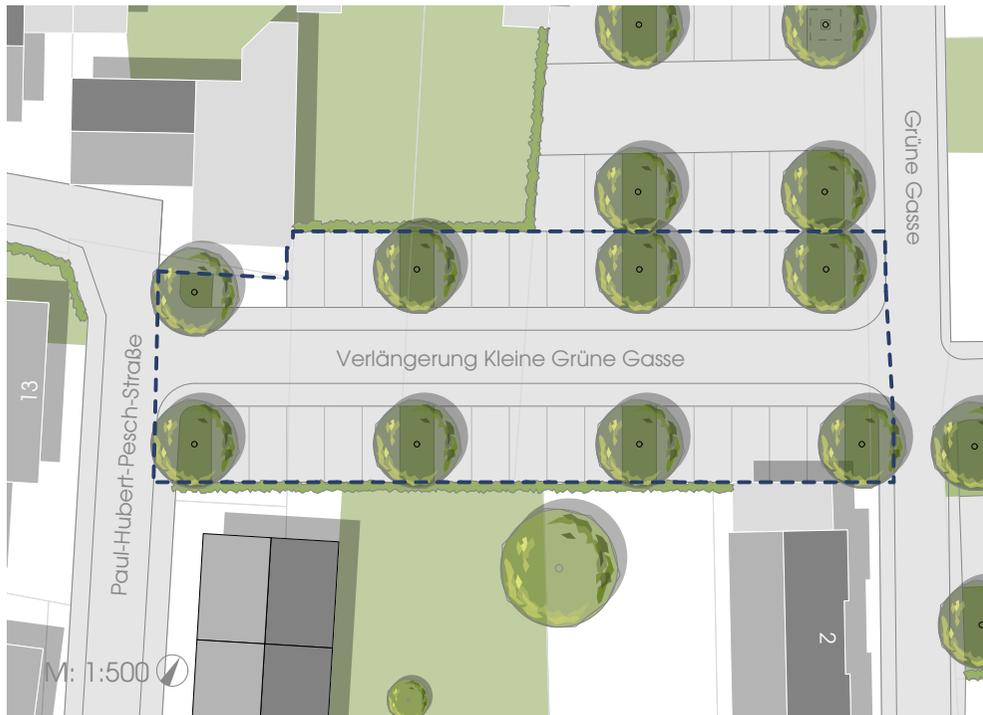
Zwischen den Straßen Grüne Gasse, Kleine Grüne Gasse und Paul-Hubert-Pesch-Straße entsteht ein Durchstich, der differenziert und barrierefrei ausgebaut wird. Die Fahrbahn von 3,50 Metern Breite wird beidseitig von Gehwegen und Senkrechtstellplätzen unter Bäumen gefasst. Die Fahrbahn wird in Asphalt ausgeführt und die Seitenbereiche in Anlehnung an die Gestaltung der Münsterstraße mit Pflaster versehen. Die Stellplätze erhalten Rasenfugenpflaster, um den grünen Charakter des Durchstichs zu
