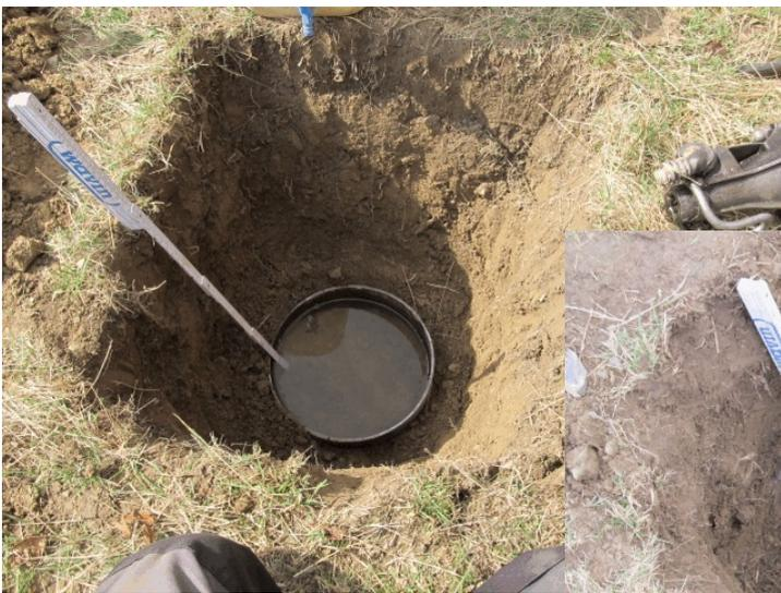
Bild 4: Sickerversuch V1 im Hanglehm
