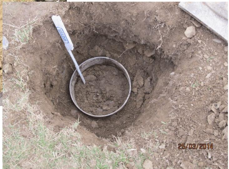
Bild 5: Sickerversuch V2 im Hangschutt
