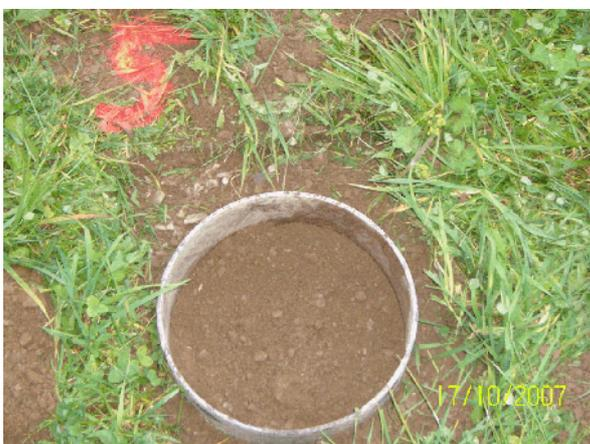
Bild 5: Sickerversuch V 5 (Fläche B)
