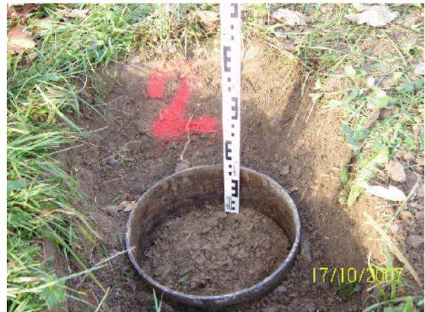
Bild 2: Sickerversuch V 2 (Fläche A)
