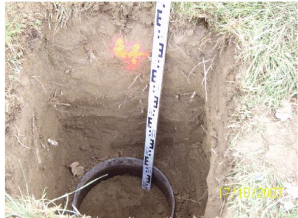
Bild 4: Sickerversuch V 4 (Fläche A)
