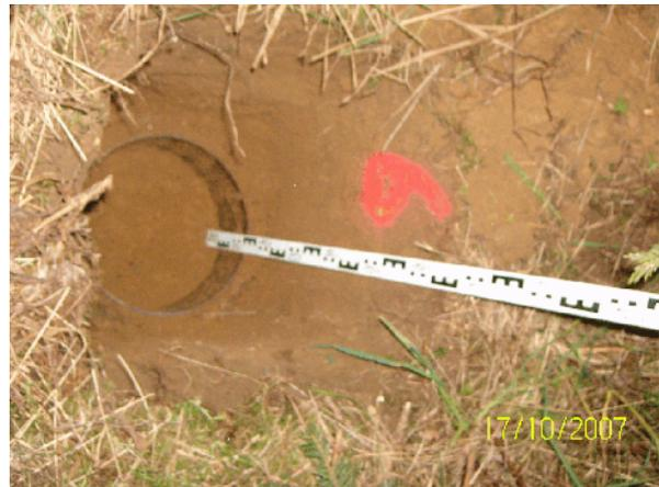
Bild 6: Sickerversuch V 6 (Fläche B)
