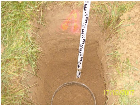
Bild 1: Sickerversuch V 1 (Fläche A)
