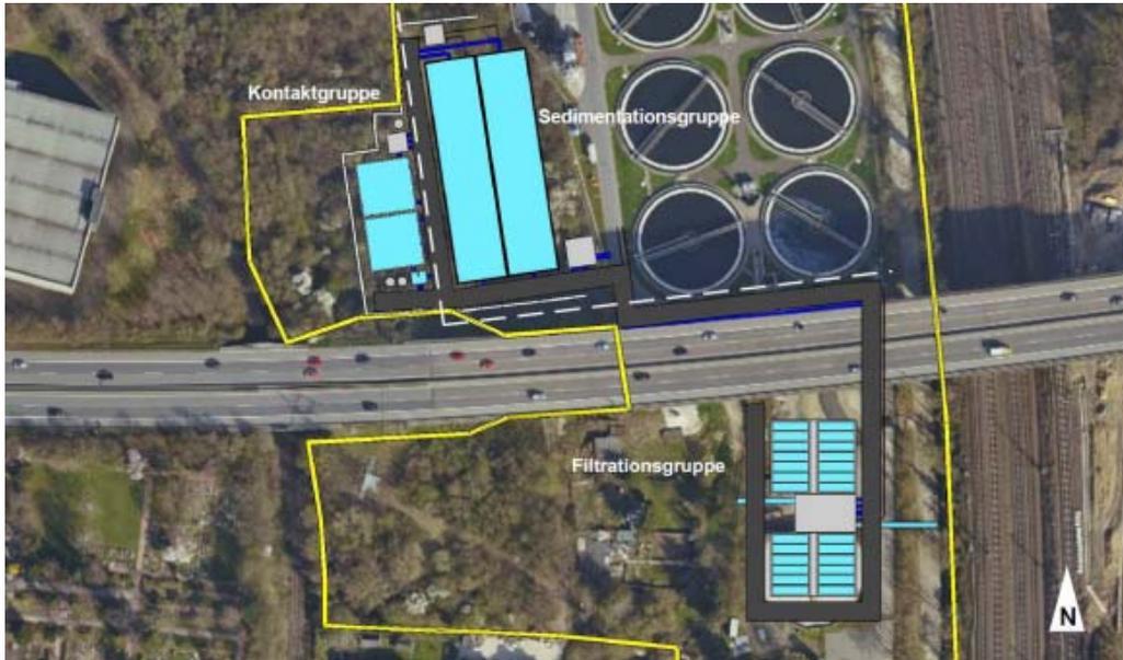
Abbildung 7: Standortvariante 11 - Darstellung einer möglichen Beckenanordnung im westlichen Hangbereich (Luftbild ELW 2011 mit Eintragungen Born & Ermel)
