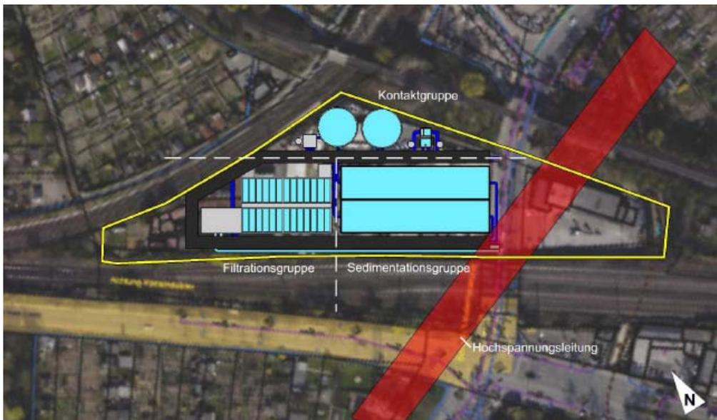
**Abbildung 11:** mögliche Anordnung der Klärtechnik für Standort 5 (Kasteler Straße Nord)
