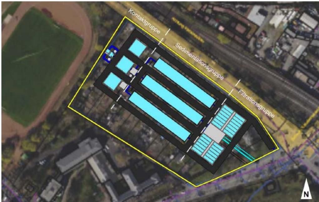
**Abbildung 13: mögliche Anordnung der Klärtechnik für Standort 7 (Güldenmark)**
