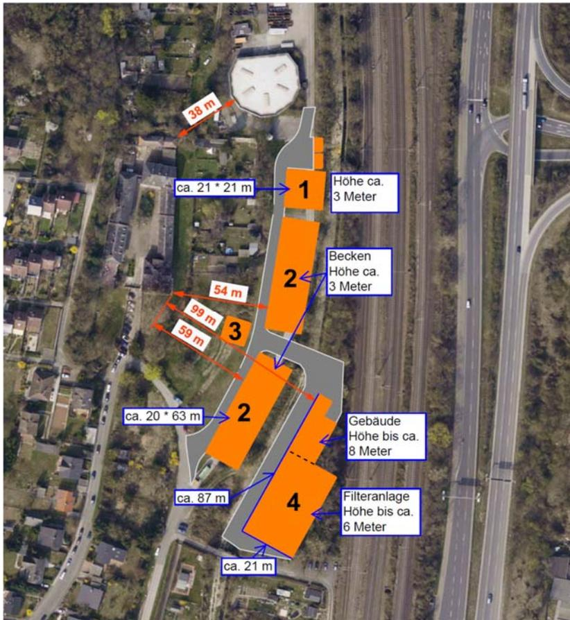
Abbildung 4: Durch die ELW „optimiertes“ Konzept der Variante 1 (PAK Verfahren) (Luftbild ELW 2011 mit Eintragungen UBS)
