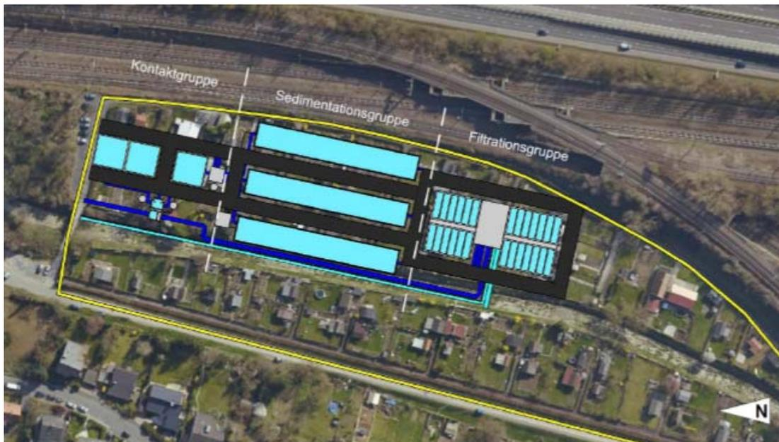
Abbildung 8: mögliche Anordnung der Klärtechnik für Standort 1 (Mühltal)
