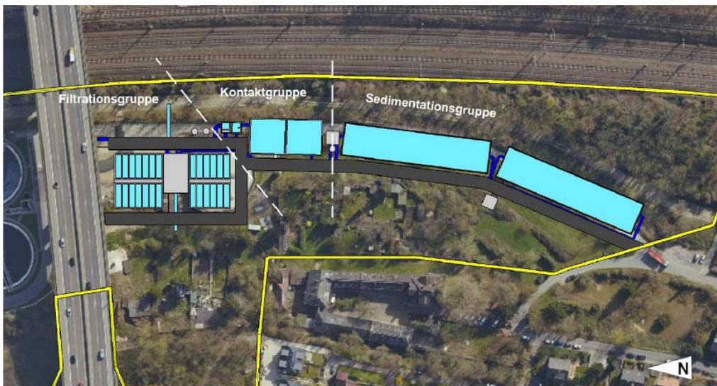
**Abbildung 6:** mögliche Anordnung der Klärtechnik der Vorzugsvariante (Standortvariante 0/HKW - Vorzugsvariante) (Luftbild ELW 2011 mit Eintragungen Born & Ermel)
