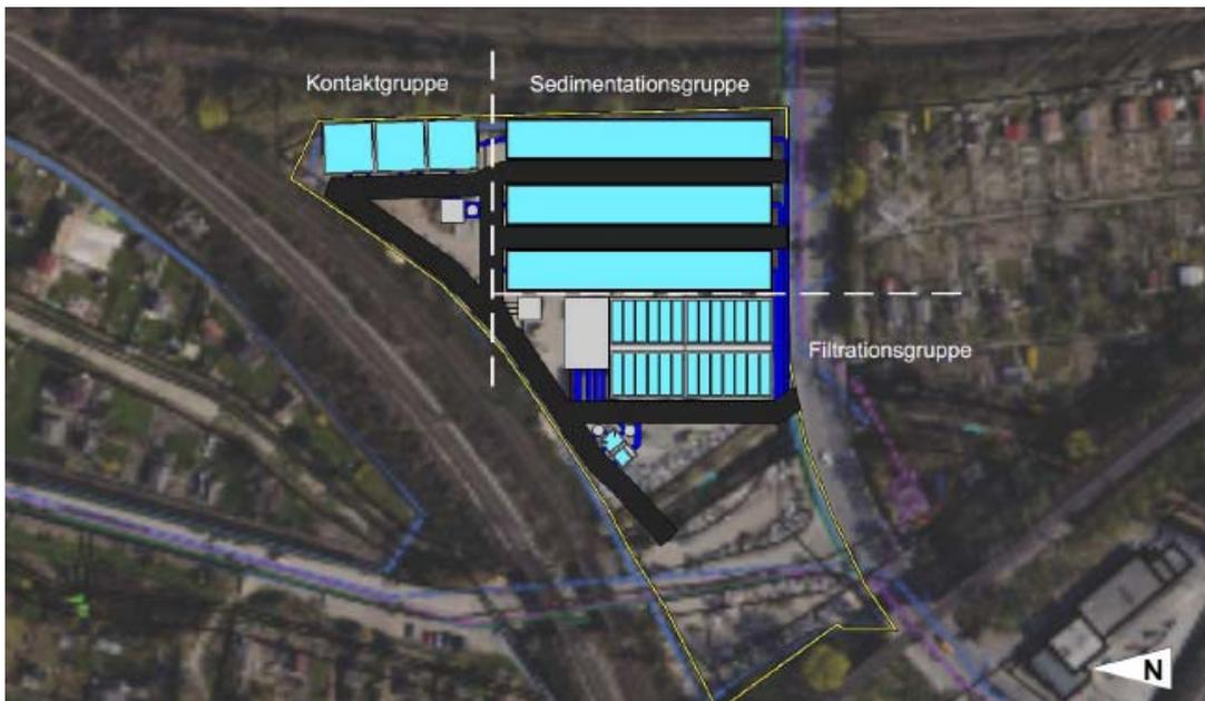
Abbildung 10: mögliche Anordnung der Klärtechnik für Standort 3 (Mainzer Straße Nord)
