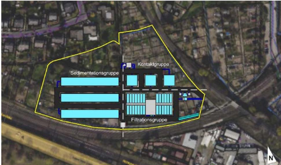
**Abbildung 12:** mögliche Anordnung der Klärtechnik für Standort 6 (Mainzer Hohl)
