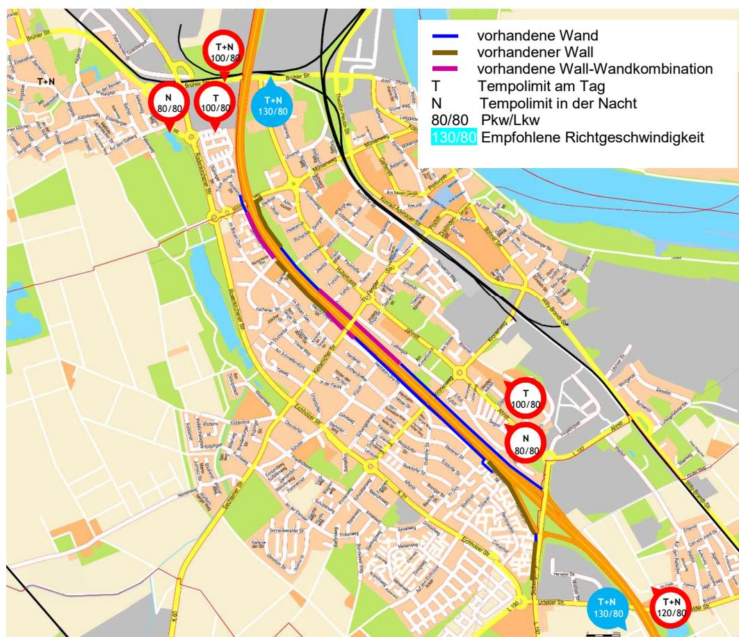
Abb. 29: Schallschutz und Tempolimits an der A 555 vor Durchführung der baulichen Lärmsanierungsmaßnahmen<sup>71</sup>
