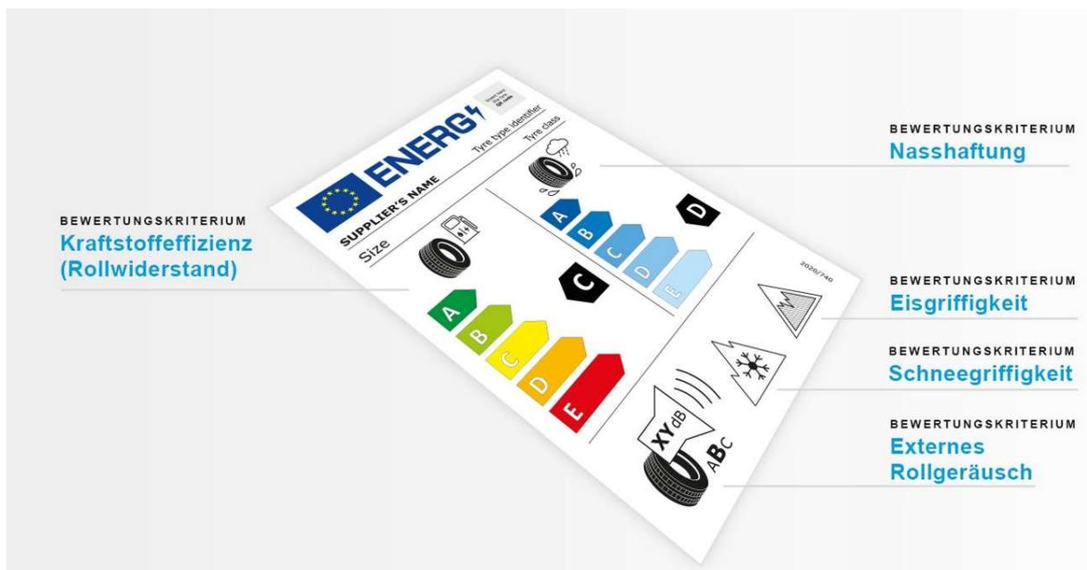
Abb. 18: Label der Europäischen Reifen-Kennzeichnungs-Verordnung 2021<sup>40</sup>
