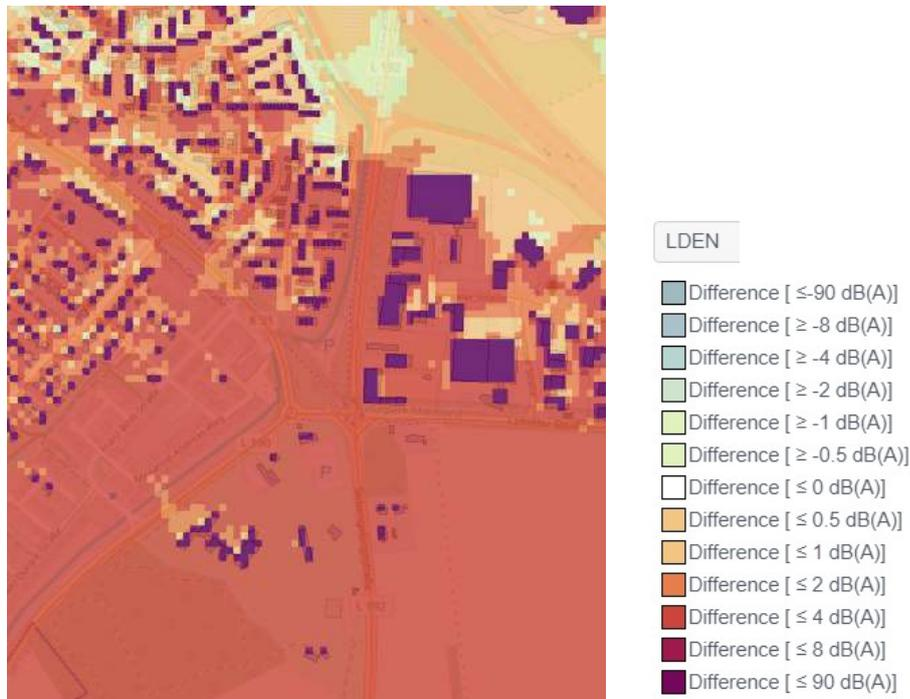
Abb. 38: Lärmpegeländerung im Malerviertel und auf dem Gelände von Schloss Eichholz bei Simulation von Tempo 50 auf der L 192 Siebengebirgsstraße südlich der Brücke über die Autobahn ( $L_{DEN}$ , eigene Berechnung nach CNOSSOS)
