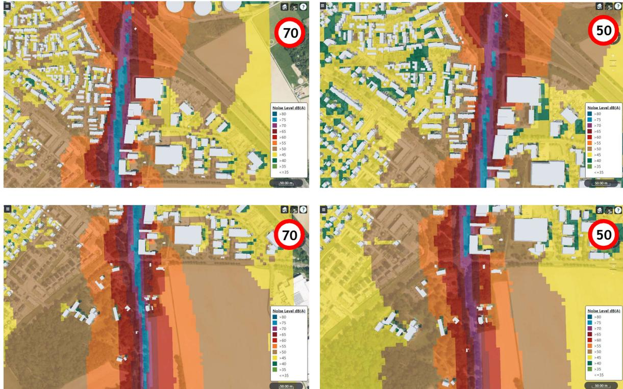
Abb. 37: Lärmpegel im Malerviertel und auf dem Gelände von Schloss Eichholz bei Tempo 70 (Bestand) und bei Simulation von Tempo 50 auf der L 192 Siebengebirgsstraße südlich der Brücke über die Autobahn ( $L_{DEN}$ , eigene Berechnung nach CNOSSOS)
