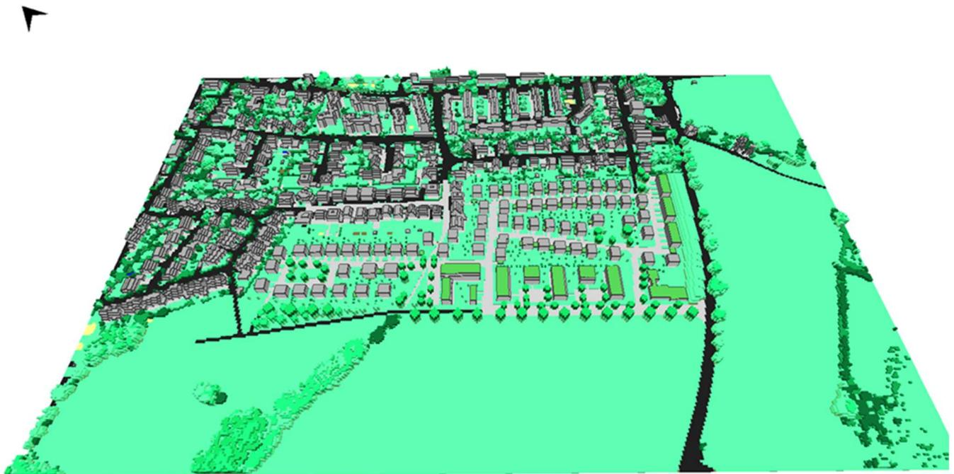
Abb. 16 Envi-met Modell für die Berechnung des Plan-Szenarios im Untersuchungsgebiet „Bellingholz-Süd“
