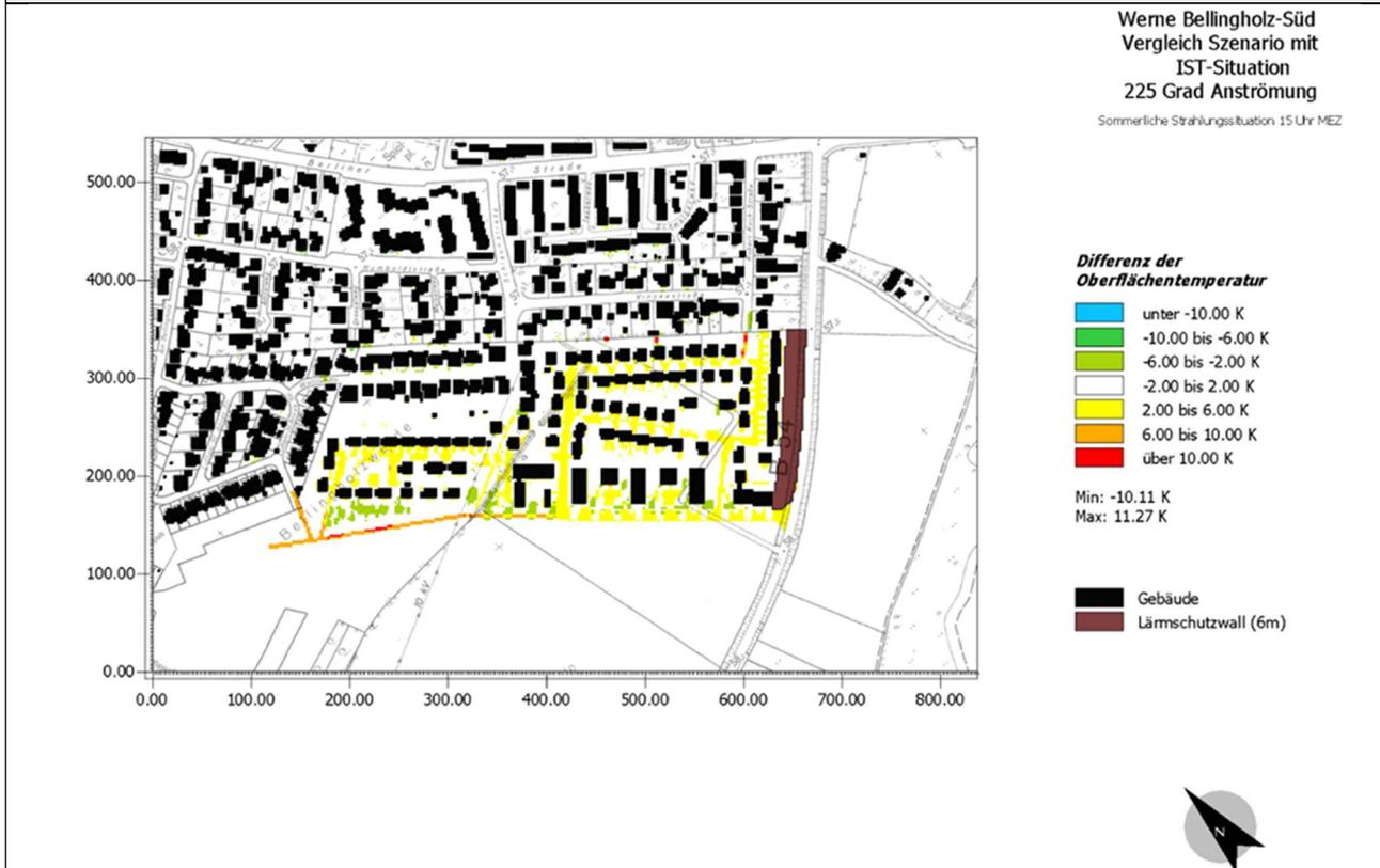
Abb. 25 Differenzen der Oberflächentemperaturen: Plan-Szenario minus IST-Zustand um 15 Uhr
