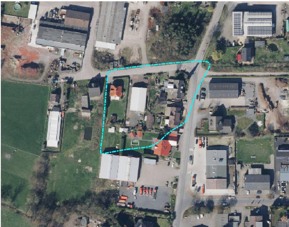
Abb. 3: Versiegelte Flächen im Oberwasser des Bauvorhabens
