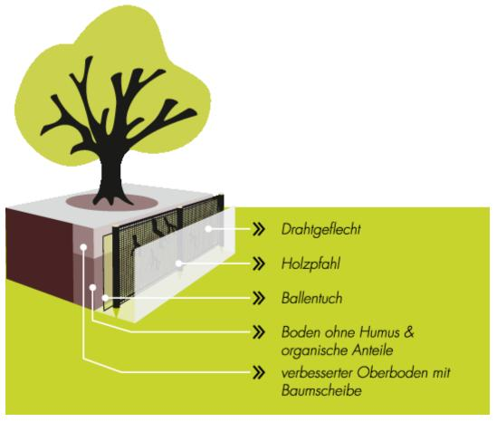
Abbildung 4: Schematische Darstellung Wurzelvorhang, Quelle: https://www.projekt-augsburg-city.de/uploads/tx\_ngnws/pac-baum-vorhang\_01.png
