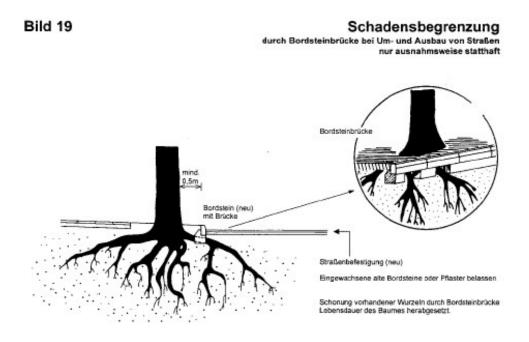
Abbildung 2: Schematische Darstellung einer Wurzelbrücke Quelle: RAS-LP 4
