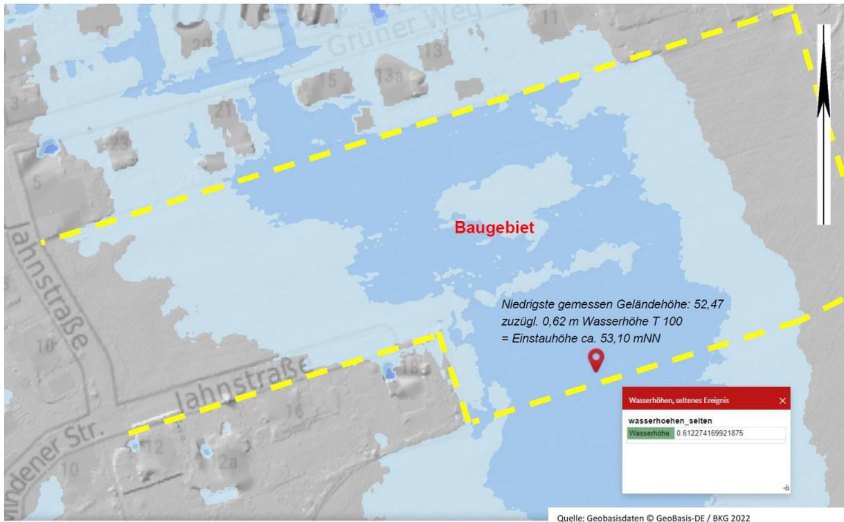
Abbildung 14: Starkregen-Einstau (Ingenieurbüro Kruse, Porta Westfalica)
