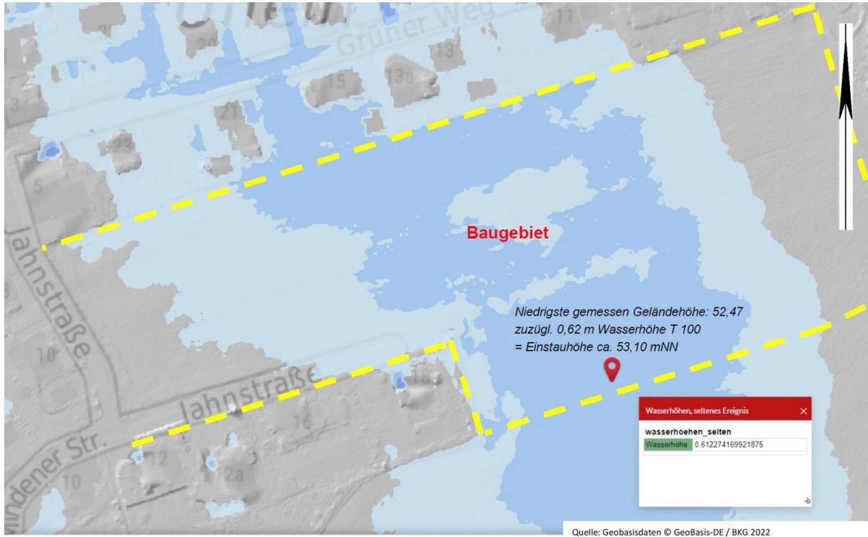
Abbildung 9: Starkregen-Einstau (Ingenieurbüro Kruse, Porta Westfalica)
