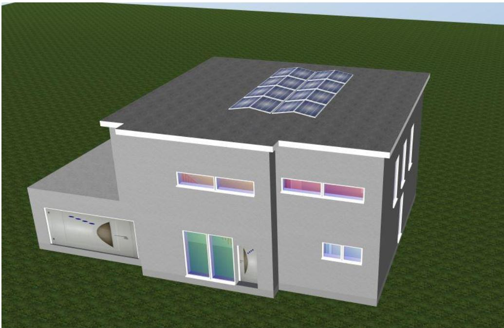
3D Simulation des EFH mit Flachdach, Ost-West-Ausrichtung und 5,68 kWp
