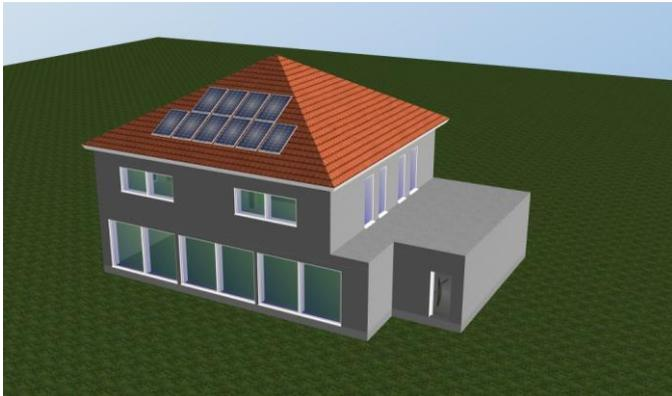
3D Simulation des EFH mit Zeltdach, Süd-Ausrichtung und 3,5 kWp
