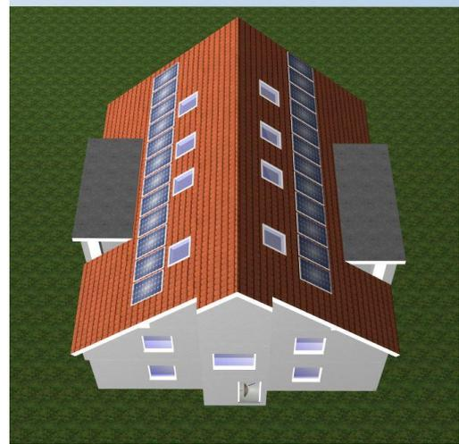
3D Simulation des MFH mit Satteldach, Ost-West-Ausrichtung und 8,52 kWp
