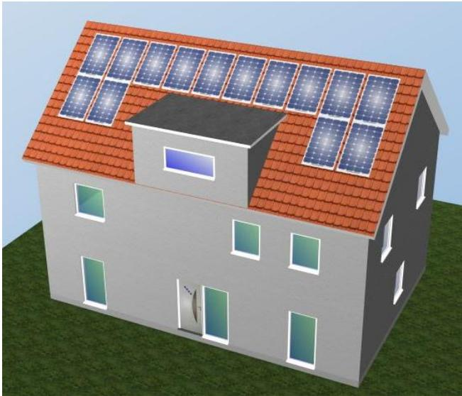
3D Simulation des EFH mit Satteldach, Süd-Ausrichtung und 3,5 kWp
