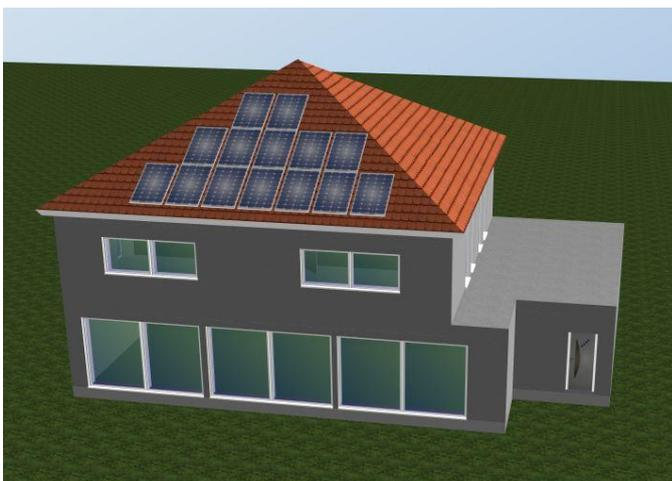
3D Simulation des EFH mit Zeltdach, Süd-Ausrichtung und 4,97 kWp
