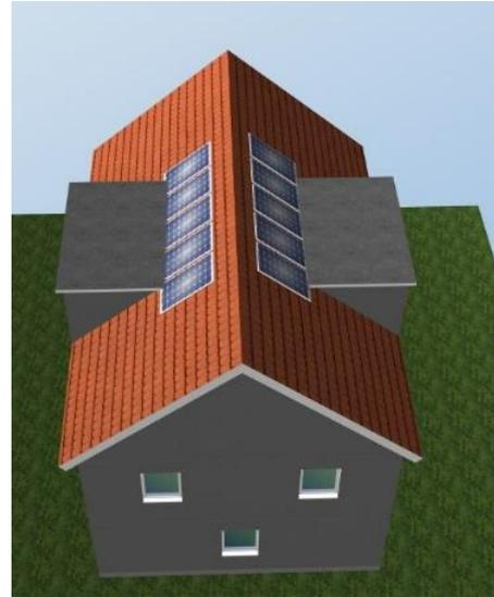
3D Simulation des EFH mit Satteldach, Ost-West-Ausrichtung und 3,5 kWp
