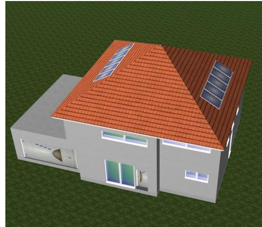
3D Simulation des EFH mit Zeltdach, Ost-West-Ausrichtung und 3,5 kWp
