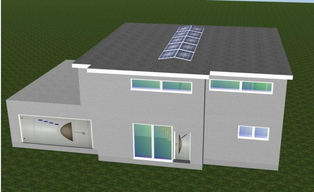
3D Simulation des EFH mit Flachdach, Ost-West-Ausrichtung und 3,5 kWp
