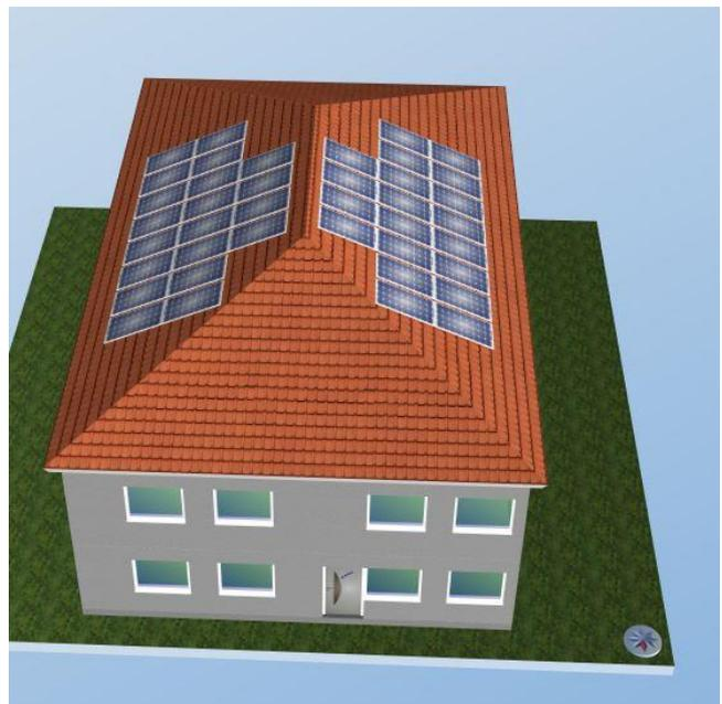
3D Simulation des MFH mit Zeltdach, Ost-West-Ausrichtung und 14,1 kWp
