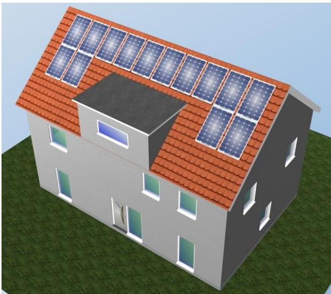
3D Simulation des EFH mit Satteldach, Süd-Ausrichtung und 4,97 kWp
