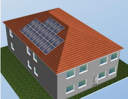
3D Simulation des MFH mit Zeltdach, Süd-Ausrichtung und 7,1 kWp
