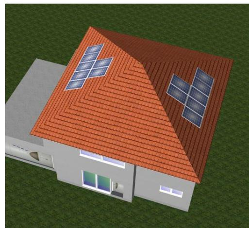
3D Simulation des EFH mit Zeltdach, Ost-West-Ausrichtung und 4,97 kWp
