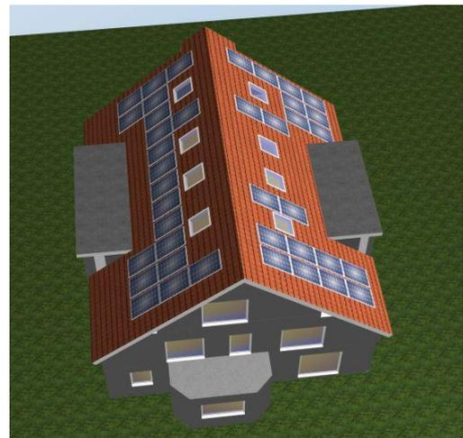
3D Simulation des MFH mit Satteldach, Ost-West-Ausrichtung und 14,2 kWp
