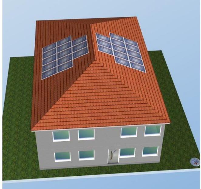
3D Simulation des MFH mit Zeltdach, Ost-West-Ausrichtung und 9,23 kWp
