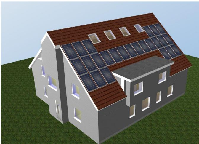
3D Simulation des MFH mit Satteldach, Süd-Ausrichtung und 8,88 kWp
