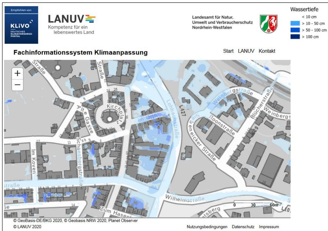
**Abb. 12: Ausschnitt Starkregenhinweiskarte, Wassertiefen bei "extremem Starkregen (90mm/h)"**
