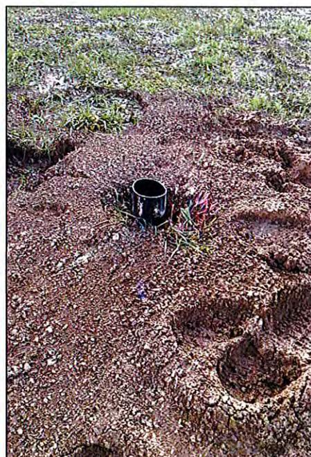
**Abb. 3: verrohrter Bohrkanal**
