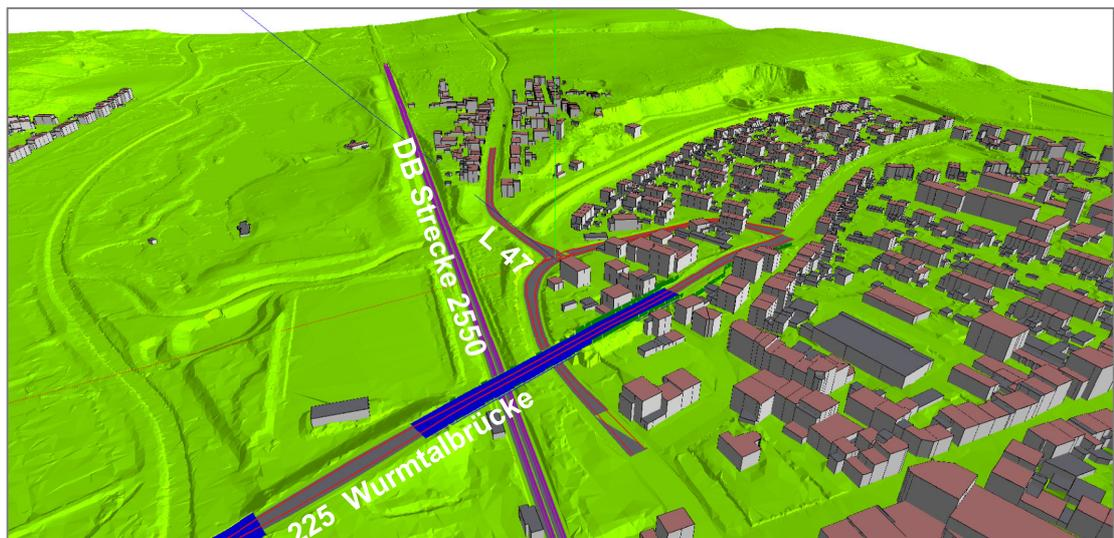
Als relevante Schallquellen wurden die L 225 (Wurmthalbrücke), die L 47 (Alte Aachener Straße), der Mühlenweg sowie die DB-Strecke 2550 als Linienschallquellen unter annähernder Berücksichtigung der Gradienten und der die Verkehrswege begleitenden Topographie in das Berechnungsmodell eingebracht.
