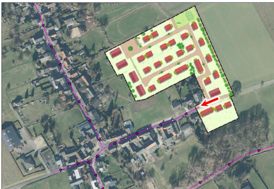
**Abbildung 5.1: Möglicher Anschluss des Schmutzwassers aus dem Erschließungsgebiet an den Bestand in der „Müntzer Straße“**
