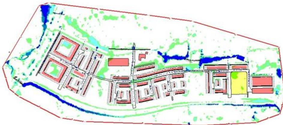
Abb. 31 Regenwasserabfluss bei Starkregen (Konzept Ing.-Büro Beck, Juni 2018)
