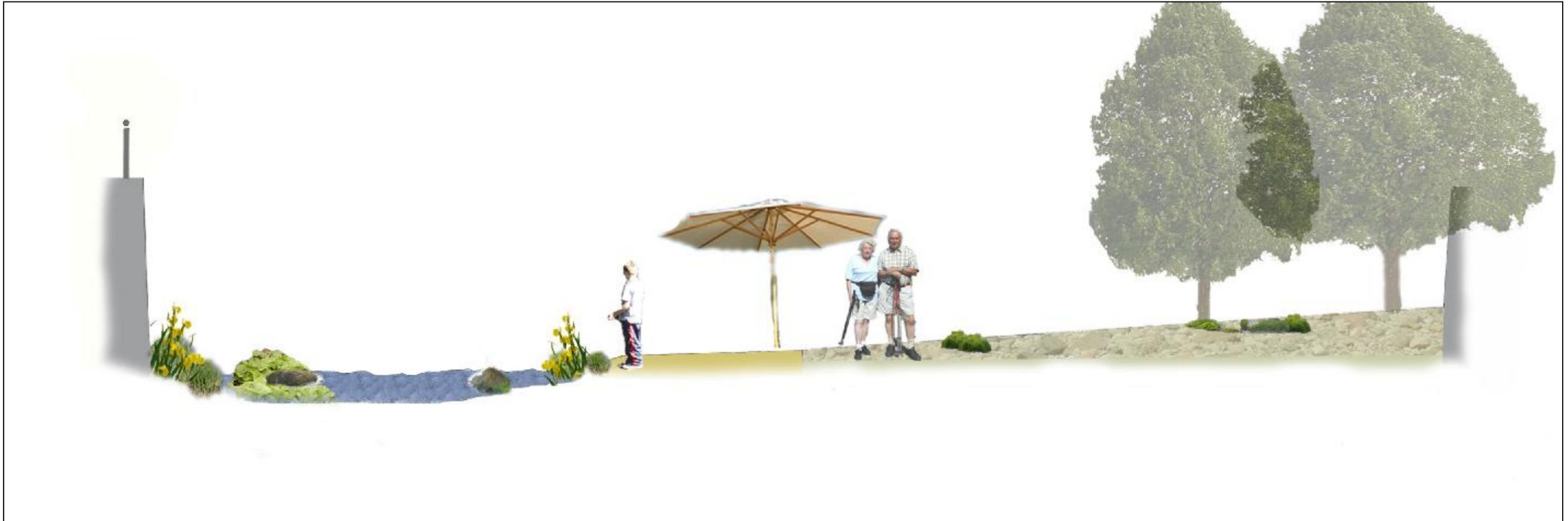
Abb. 23: Schnitt durch die geplante Ersatzaue auf der Höhe des historischen Waschplatzes und der Cafeterrasse am Wächplatz – links wird die Ersatzaue durch die bestehende, zu verblendende Ufermauer abgegrenzt. Rechts müsste eine neue Ufermauer die Aue gegenüber den angrenzenden Verkehrsflächen abgrenzen. Die gesamte Aue wäre auf den zu schaffenden KiesSchotterbänken begehbar.
