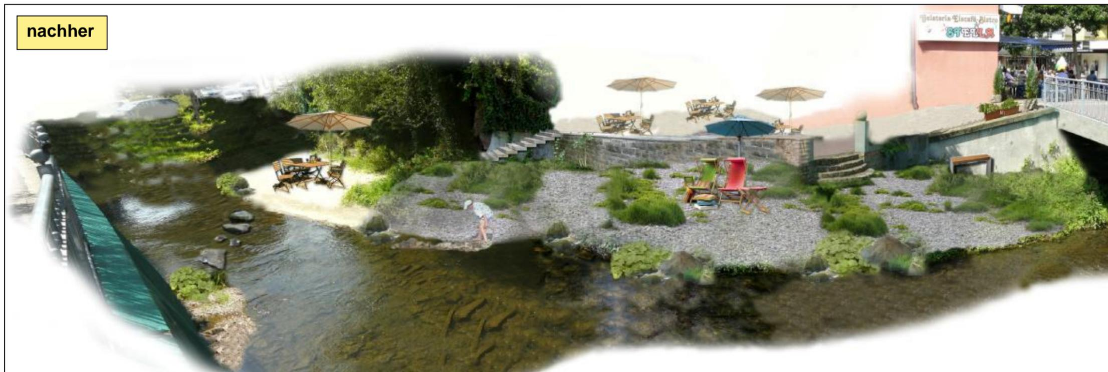
Abb. 21: So könnte das linke Ufer im Bereich des Levi-Klein-Platzes umgestaltet werden (UIH-Fotomontage): Die sanierungsbedürftige Brücke könnte entfernt werden, so dass der gesamte Uferbereich auf ca. 70 m Länge begangen werden könnte. Vor der umzugestaltenden Eiscafeterrasse könnten naturnahe Ufer aus Bachschotterflächen einen gefährlosen Zugang ans Wasser gewährleisten: Zugänge von der Terrasse ans Ufer und zum ehemaligen Waschplatz ermöglichen einen direkten Kontakt zum Wasser.
