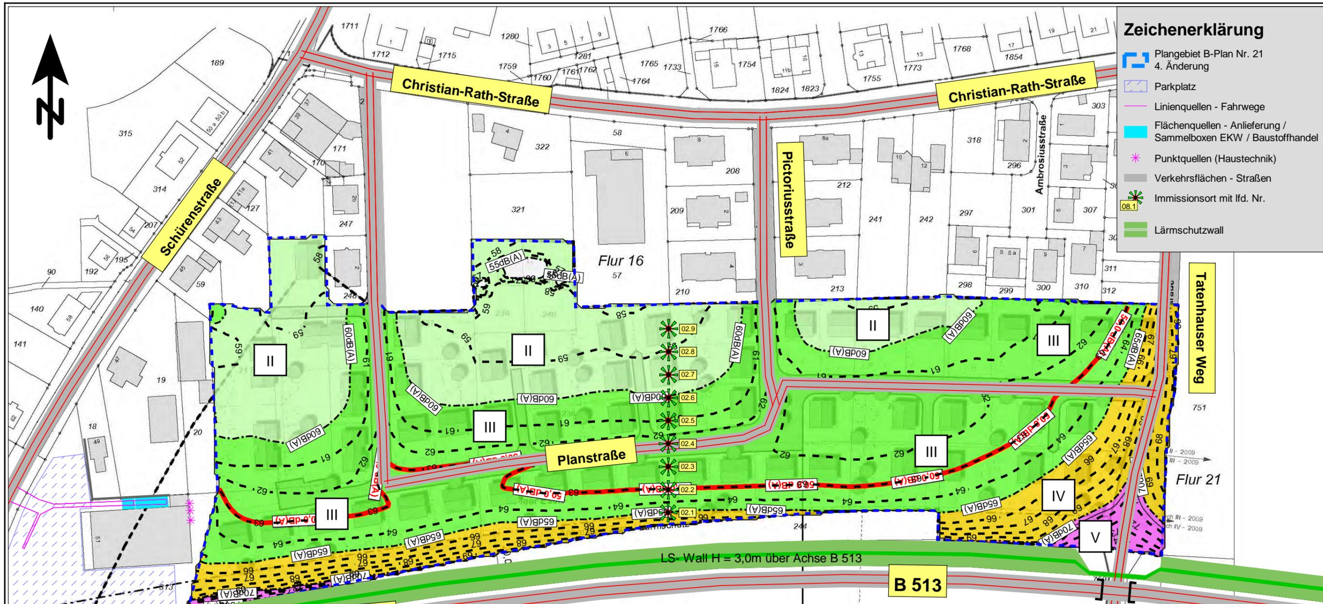
maßgeb. Außenlärmpegel in dB(A) mit Zuordnung der Lärmpegelbereiche nach DIN 4109
