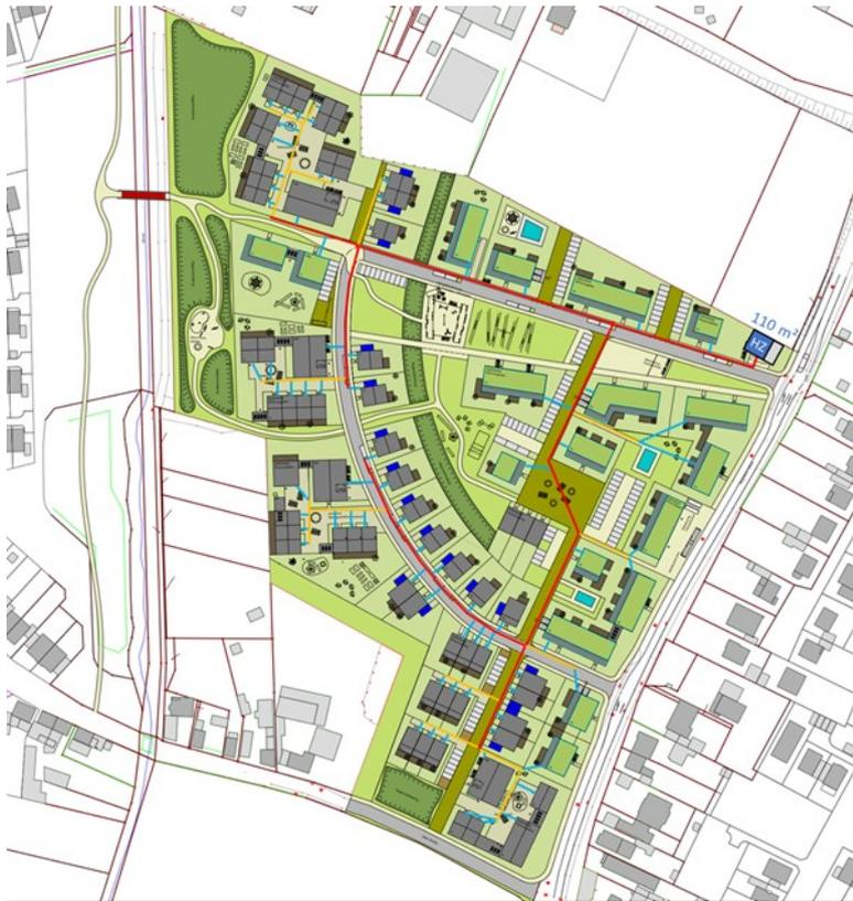
Abbildung 12 Wärmenetz und Anbindung Heizzentrale
