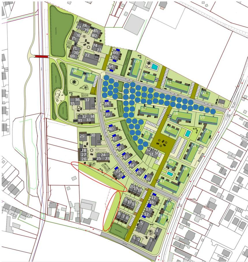
Abbildung 13 Mögliche Geothermie-Erdsonden-Verteilung
