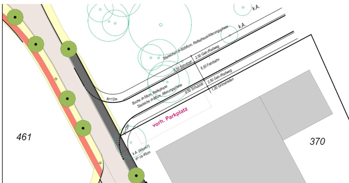
Abbildung 10: Planskizze der Einmündung in die Morsestraße mit Straßenquerschnitt
