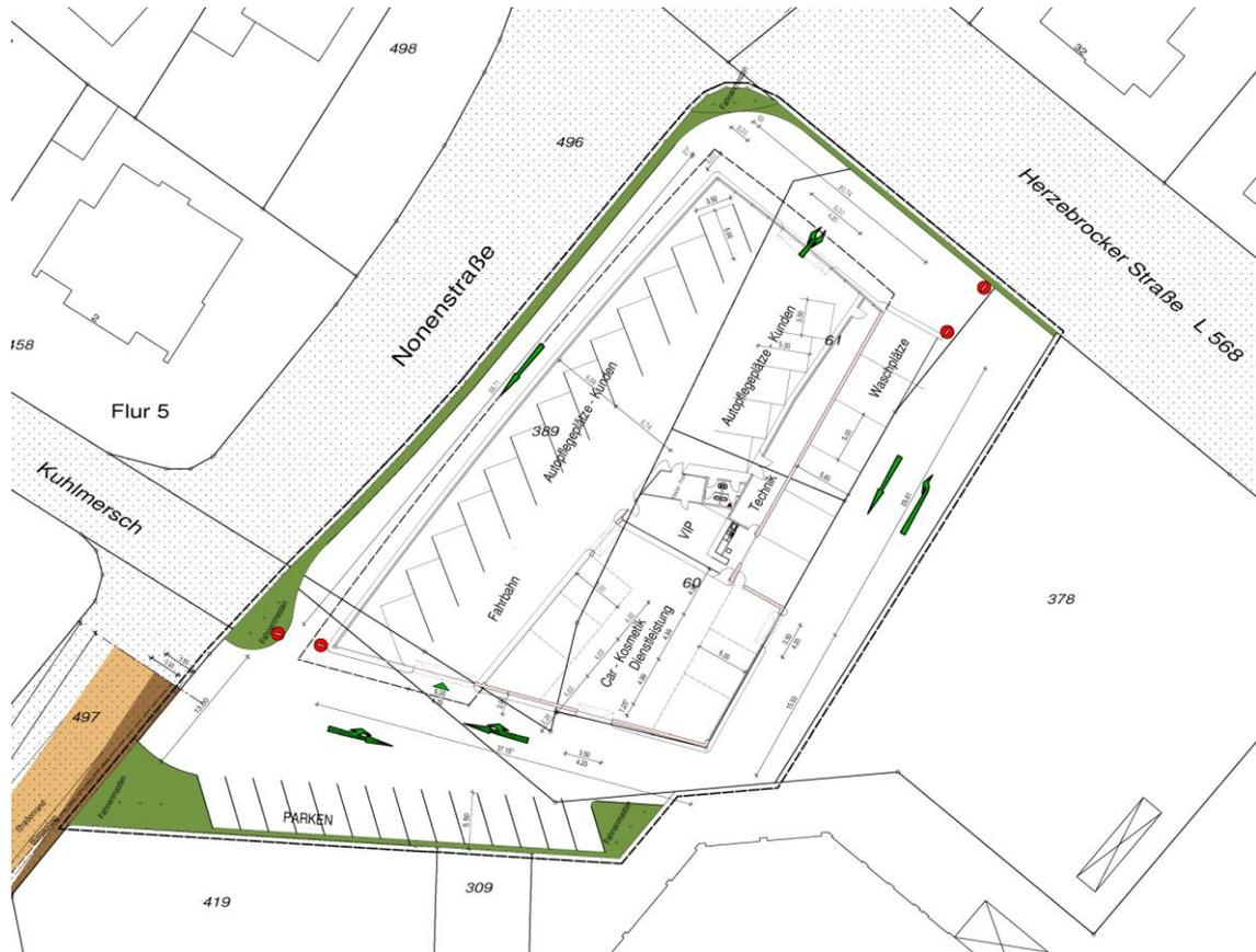
Abb. 1: Lageplan der geplanten KFZ-Pflegestation
