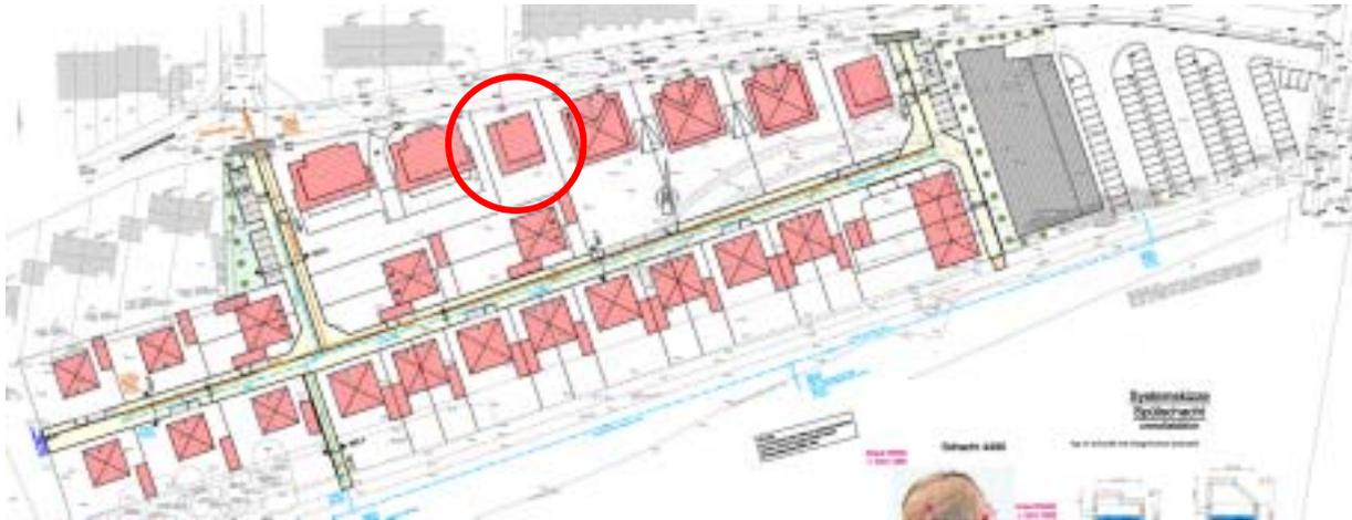
Ein Grundstück (geplantes Haus Nr. 36, in der Karte markiert) an der Talstraße ist im Hinblick auf das Niederschlagswasser nicht durch die geplanten Erschließungsanlagen erschlossen. Daher wird das Regenwasser zusammen mit den häuslichen Schmutzwässern über einen Anschlussstutzen an den Mischwasserkanal in der Talstraße direkt angeschlossen. Der Übergabeschacht liegt auf dem Grundstück.
