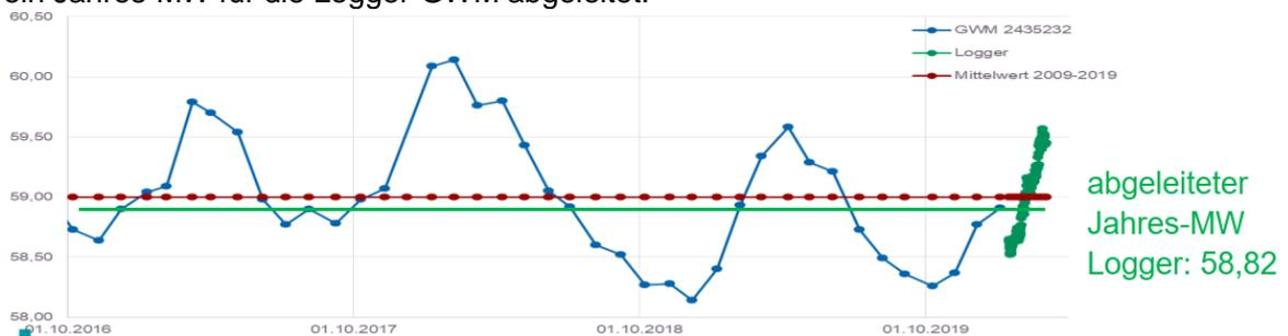
**Abbildung 18:** *Ermittlung eines Jahresmittels durch Anpassung des langfristig gemessenen Mittelwerts (2008-2019) eines benachbarten Pegels an die örtlichen Loggerdaten (GWM XY) aus dem Januar 2020 (Abgleich der gemessenen Januar-Mittelwerte).*
