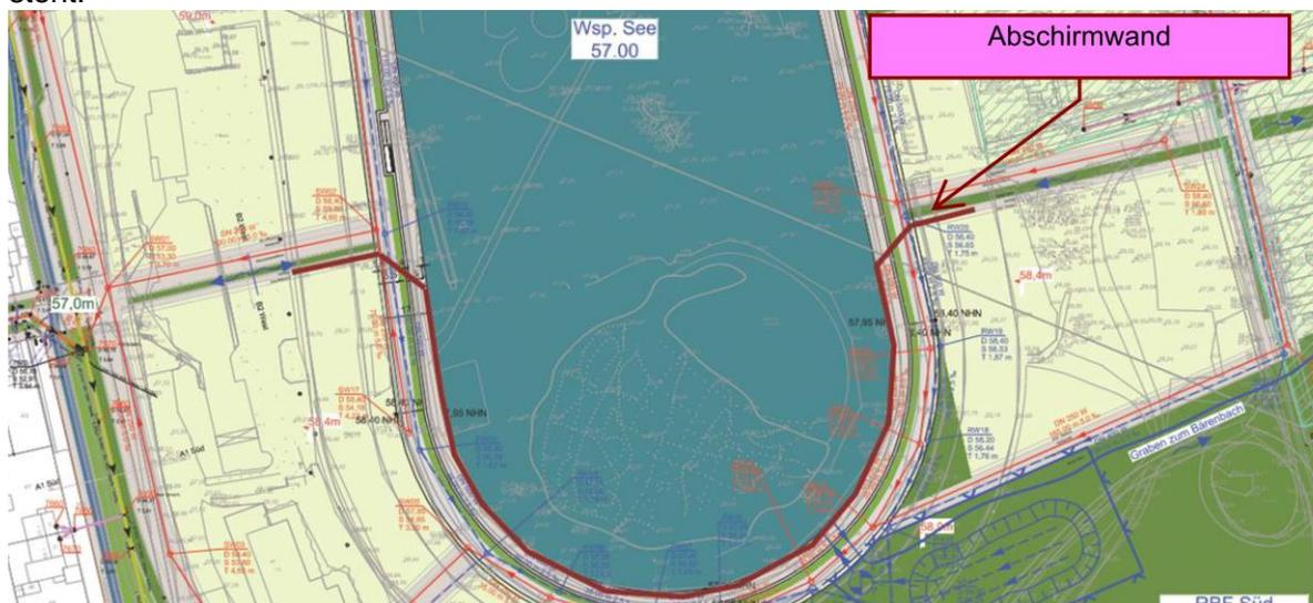
**Abbildung 26: Gespundete Abschirmwand am südlichen Seekopf und entlang der beiden Flanken**
