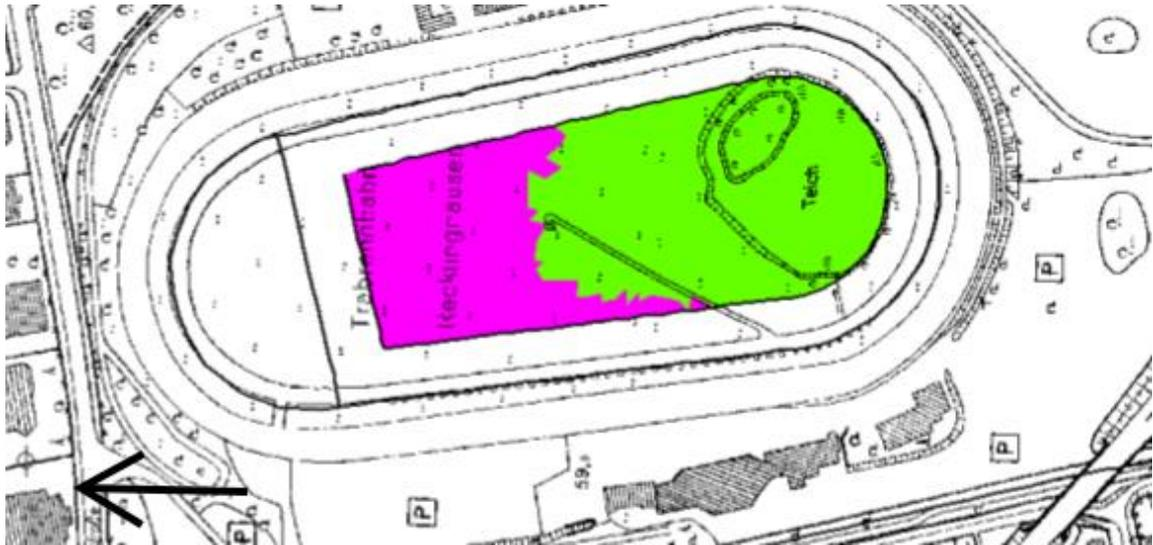
**Abbildung 19: Grundwasserzu- (pink) und -abstrombereich (grün) gemäß Grundwassermodell für den Planungszustand, ohne Sohlabdichtung**
