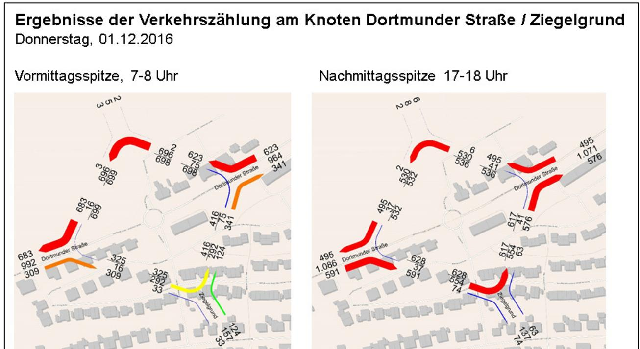
Abbildung 9: Darstellung der Zählungsergebnisse am Kreisverkehr Dortmunder Straße / Ziegelgrund in Form eines vierarmigen Knotenpunktes (zur besseren Erkennbarkeit der Abbiegeströme)
