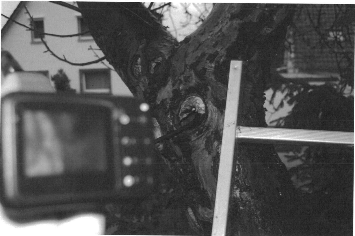
**Abb. 7:** Untersuchung der Fäulnishöhlen mit einem Endoskop
