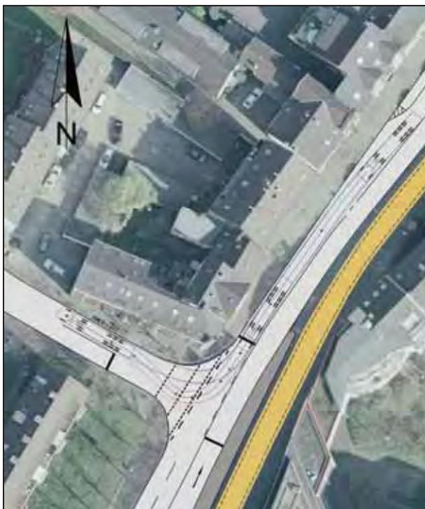
Abbildung 41: Schleppkurve für einen Sattelzug
