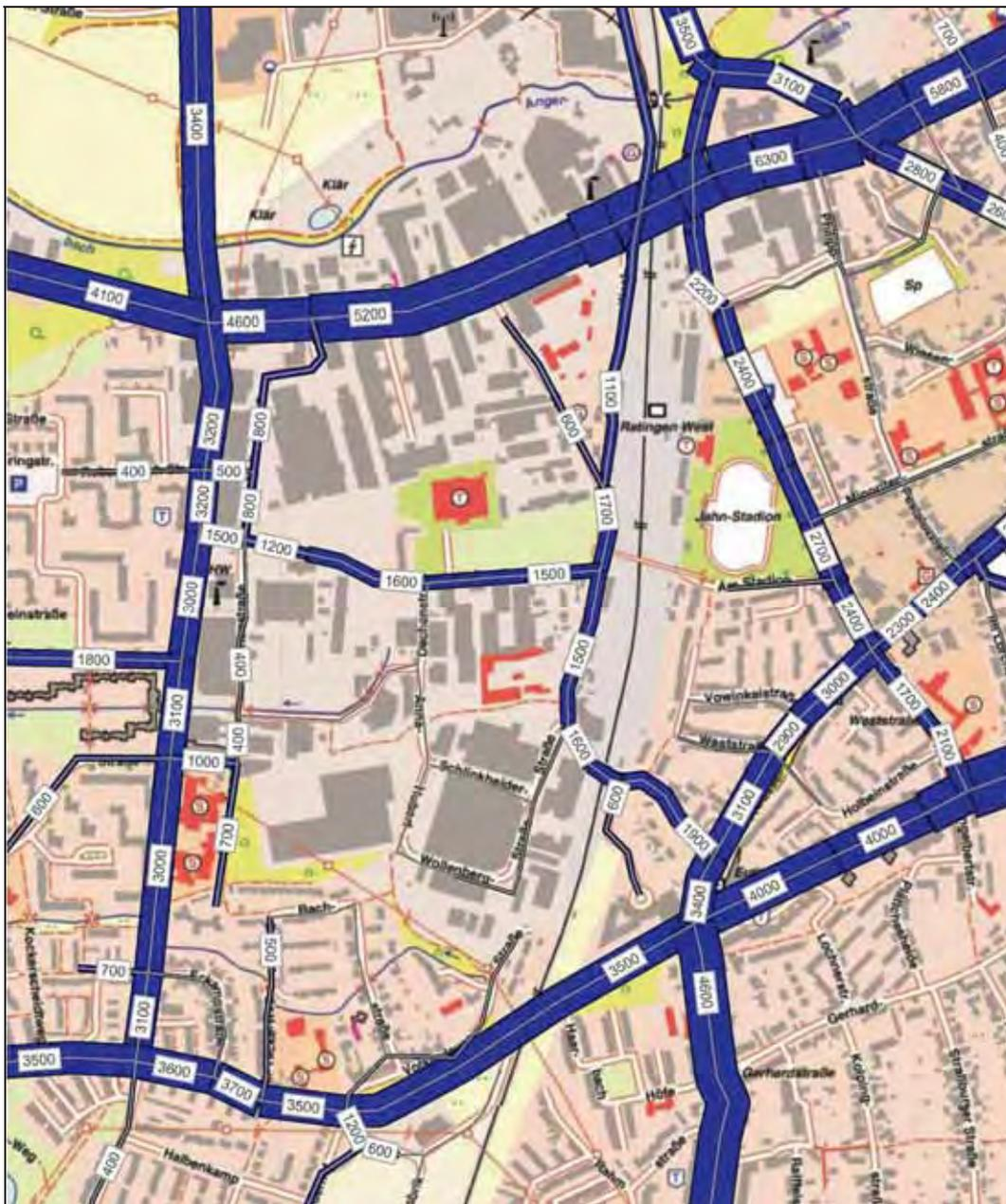
Abbildung 17: Verkehrsaufkommen für Netzfall 1 im Analysefall (Zeitraum 6-10 Uhr) [ Kfz/4h ]
