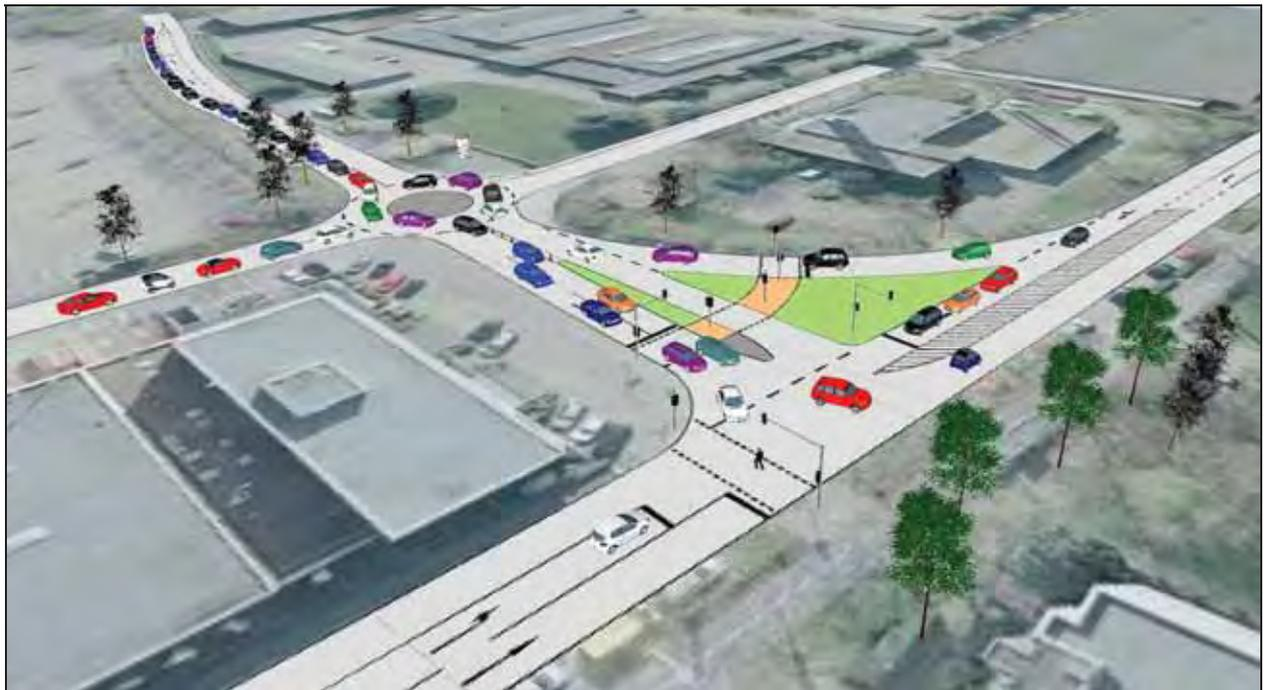
Abbildung 70: Ausschnitt aus der Simulation – Rückstau am Kreisverkehr Lise-Meitner-Straße im Netzfall 4
