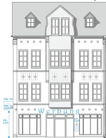
Abbildung 3: Dimensionierung von Werbeanlagen
