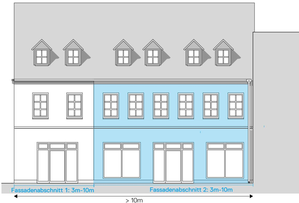
**ABB 024** Prinzip Fassadenbreite: Gliederung breiter Fassaden in ablesbare Fassadenabschnitte
