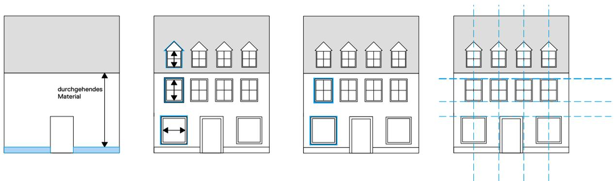
**ABB 035** Prinzip Fassadengliederung: durchgehend in einem Material und einer Farbe gestaltete Fassade mit Sockel
