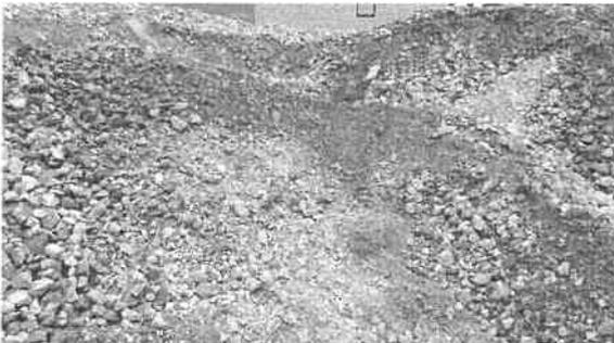
Abbildung 2: Bauschutt organoleptisch unauffällig
