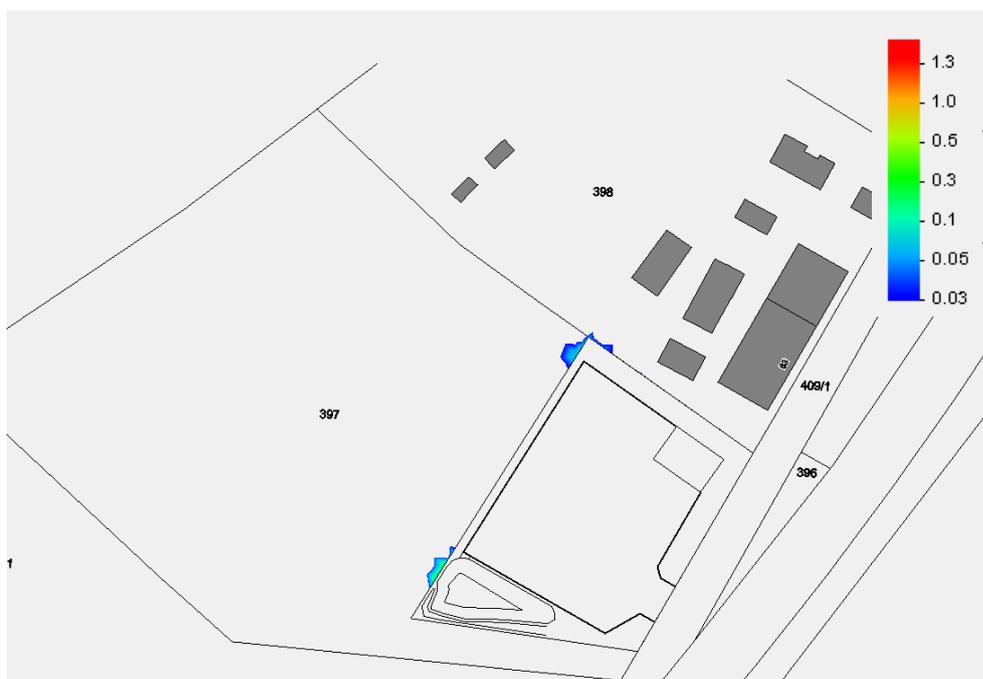
Abbildung 16: Wassertiefendifferenz Bestand / Worst-Case Variante; Differenz in [m]
