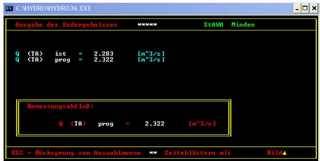
Abbildung 4: Ergebnis HYDRO36, aktuelle Abflusssituation ( $Q_{IST}=2,283$  m<sup>3</sup>/s) und nach Bau des Neubaugebietes ( $Q_{PROG}=2,322$  m<sup>3</sup>/s)
