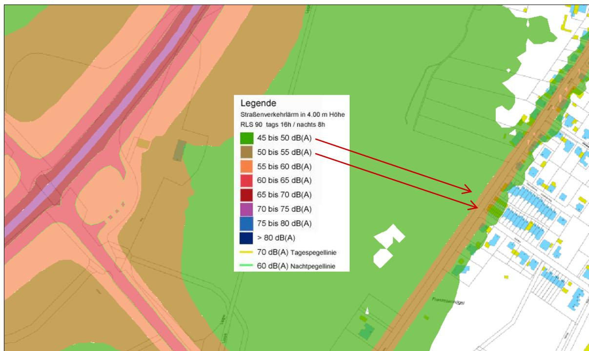
**Straßenlärm nach der RLS-90 (Richtlinie für den Lärmschutz an Straßen – Ausgabe 1990) in Verbindung mit der Verkehrslärmschutzverordnung (16. BImSchV) und der Verordnung für die Lärmkartierung (34. BImSchV);**
