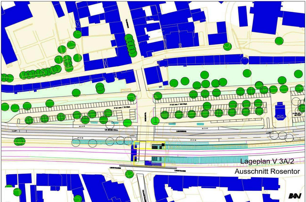
Abb. 12 Entwurfsplanung für die Vorzugsvariante : Verschwenkung der Fahrbahn an die Gleise, dadurch unmittelbare Nachbarschaft der Omnibushaltestelle und des geplanten DB-Haltepunktes Rosentor, Liborikapelle transloziert
