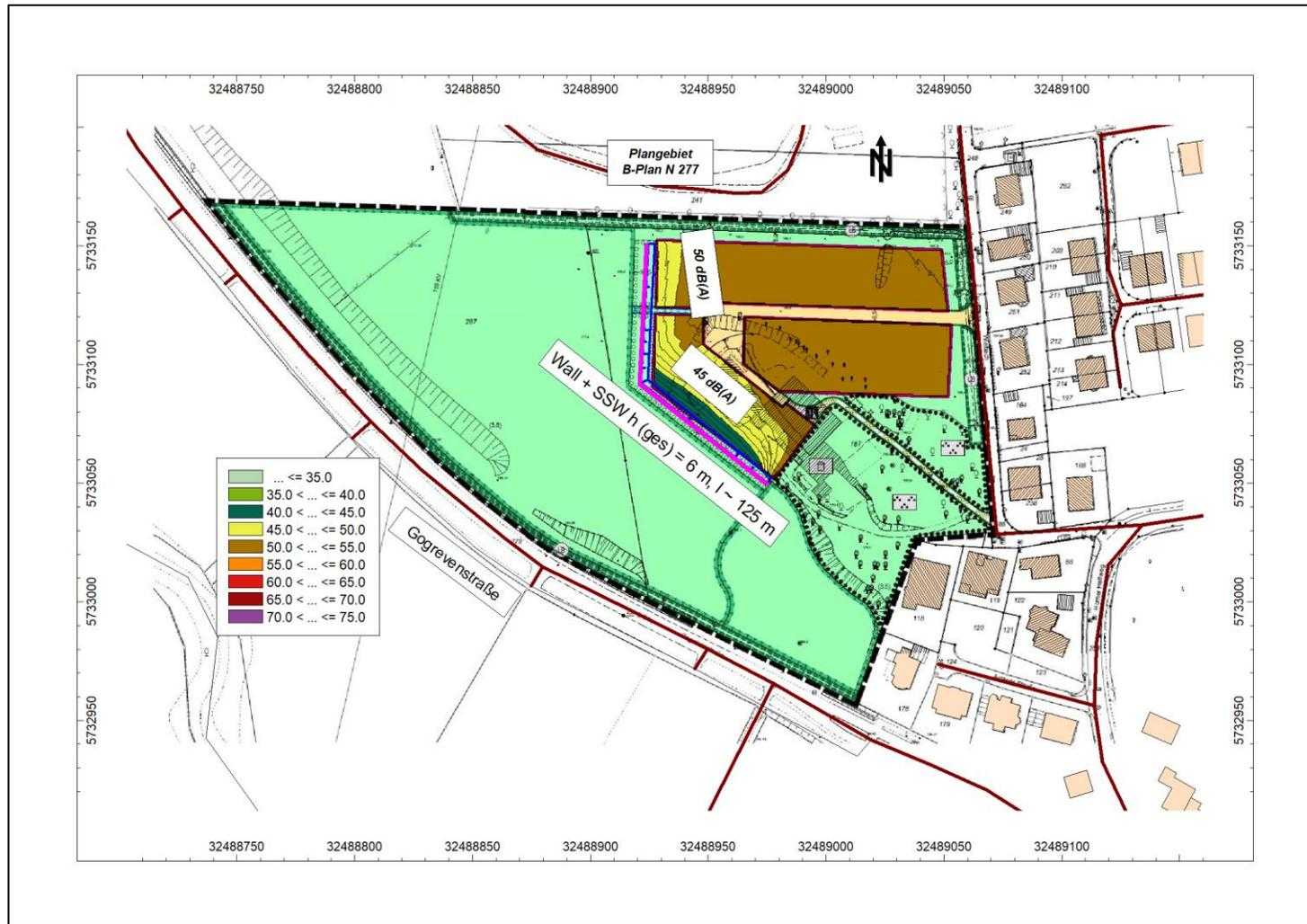
**A17 Beurteilungspegel (Schiene und Straße) – Lageplan, Var. 2: Wall + Wand h = 6 m, Rechenhöhe h = 4 m ü. B.**
