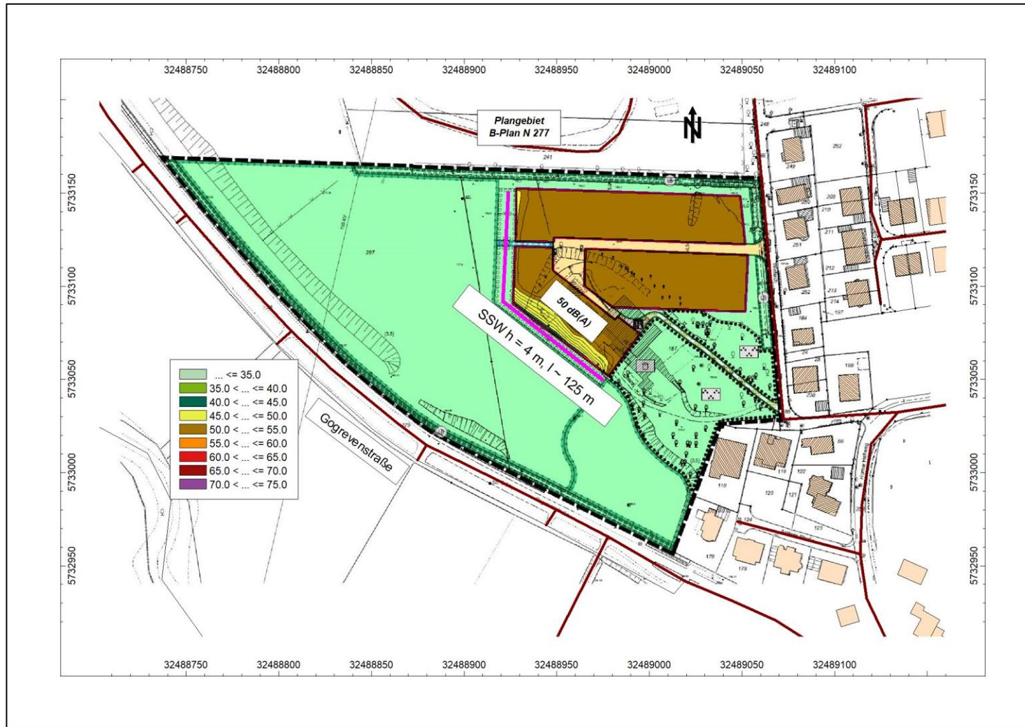
**A14 Beurteilungspegel (Schiene und Straße) – Lageplan, Var. 1: Wand h = 4 m, Rechenhöhe h = 4 m ü. B.**
