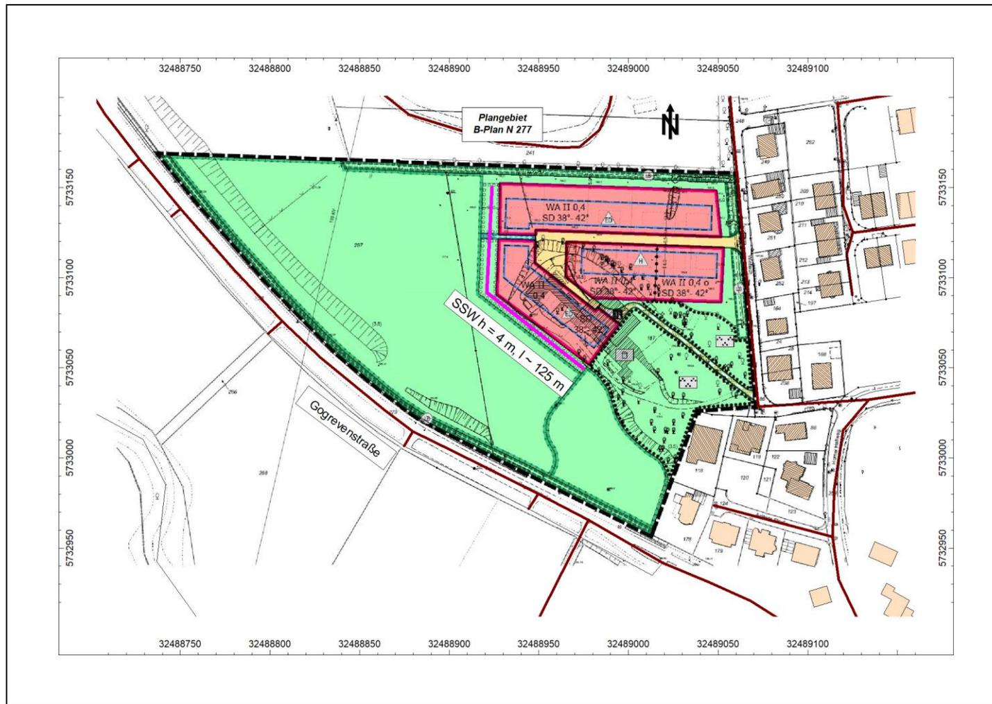
**A12 Schallschutzmaßnahmen im Plangebiet – Lageplan, Var. 2: Wall h = 3 m mit Wand h = 3 m (Gesamthöhe h = 6 m)**
