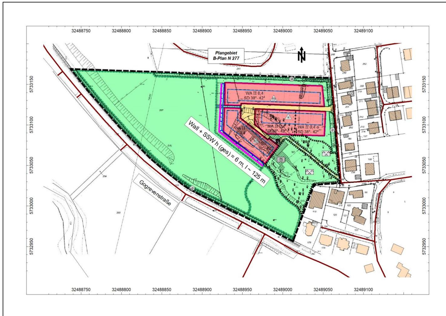
**A13 Beurteilungspegel (Schiene und Straße) – Lageplan, Var. 1: Wand h = 4 m, Rechenhöhe h = 2 m ü. B.**
