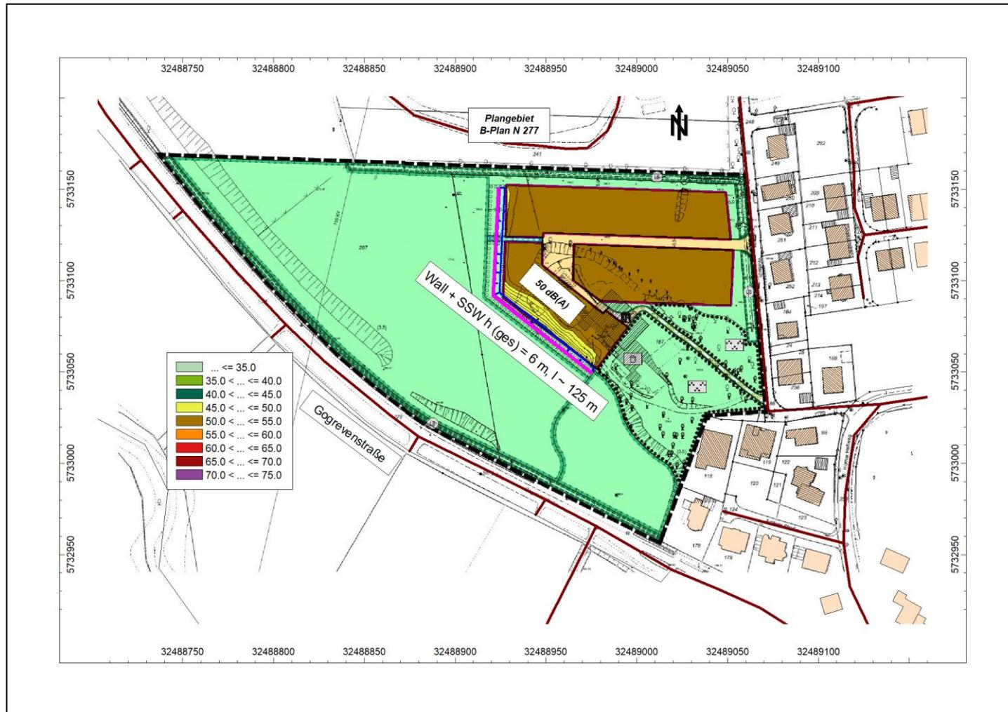
**A18 Beurteilungspegel (Schiene und Straße) – Lageplan, Var. 2: Wall + Wand h = 6 m, Rechenhöhe h = 6 m ü. B.**
