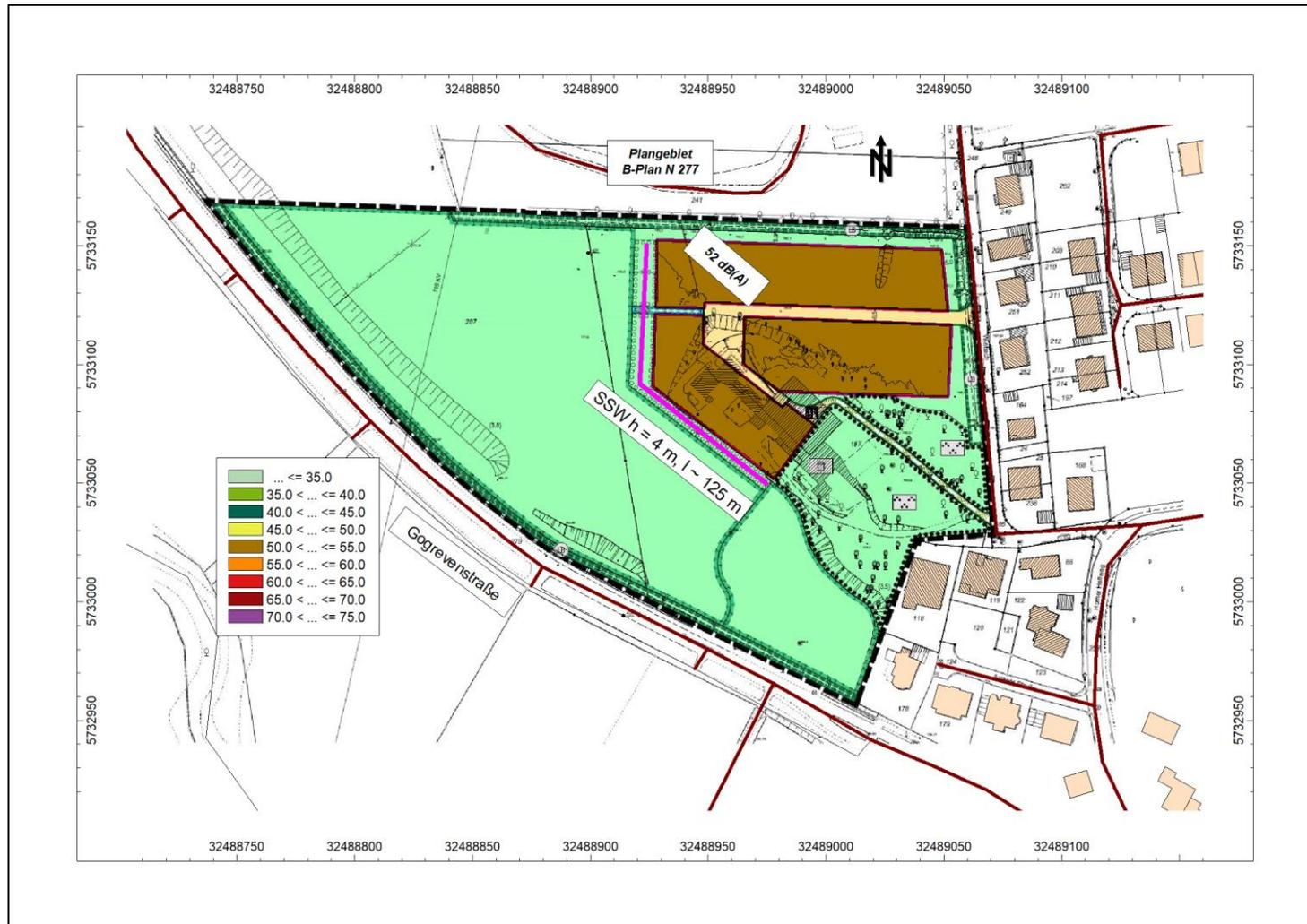
**A15 Beurteilungspegel (Schiene und Straße) – Lageplan, Var. 1: Wand h = 4 m, Rechenhöhe h = 6 m ü. B.**
