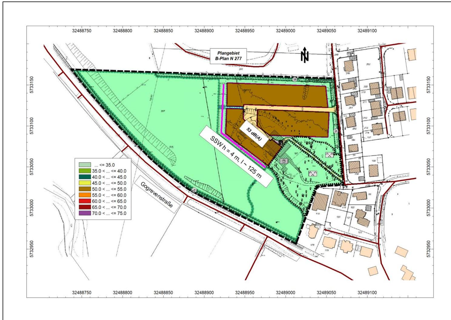
**A16 Beurteilungspegel (Schiene und Straße) – Lageplan, Var. 2: Wall + Wand h = 6 m, Rechenhöhe h = 2 m ü. B.**
