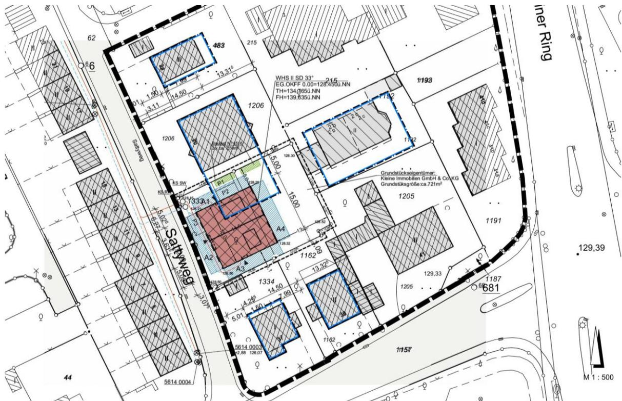
Abb. 6: Überlagerung des Bauvorhabens mit dem bestehenden Bebauungsplan (ohne Maßstab)
