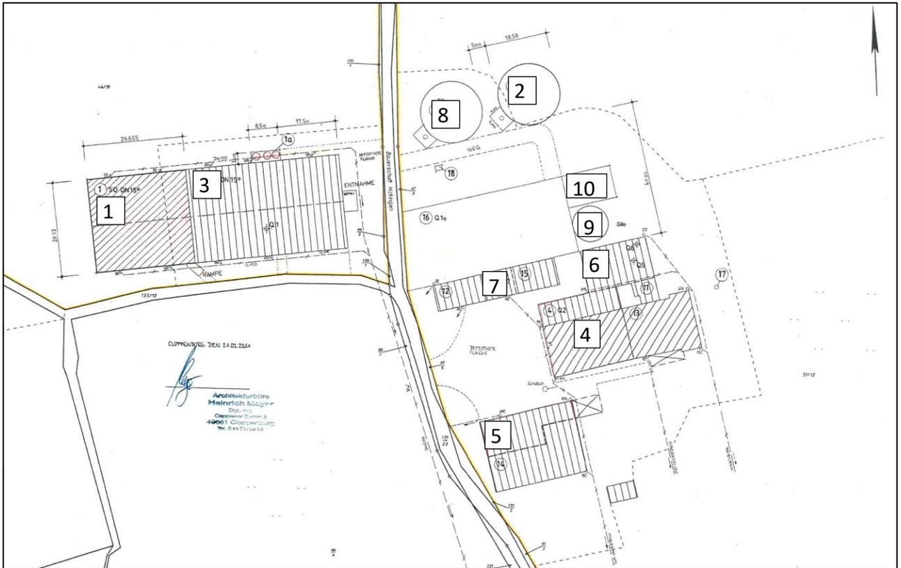
**Abbildung 4: Gebäudenutzung Hof Große-Schawe (1: Schweinestall mit Abluftreinigung, 2 Güllehochbehälter, 3: Schweinemaststall, 4: Rinderstall, 5: Rinderstall, 6: Schweinemaststall, 7: Krankenstall, 8: Güllehochbehälter, 9: Güllehochbehälter (stillgelegt), 10: Festmistplatte(stillgelegt))**
