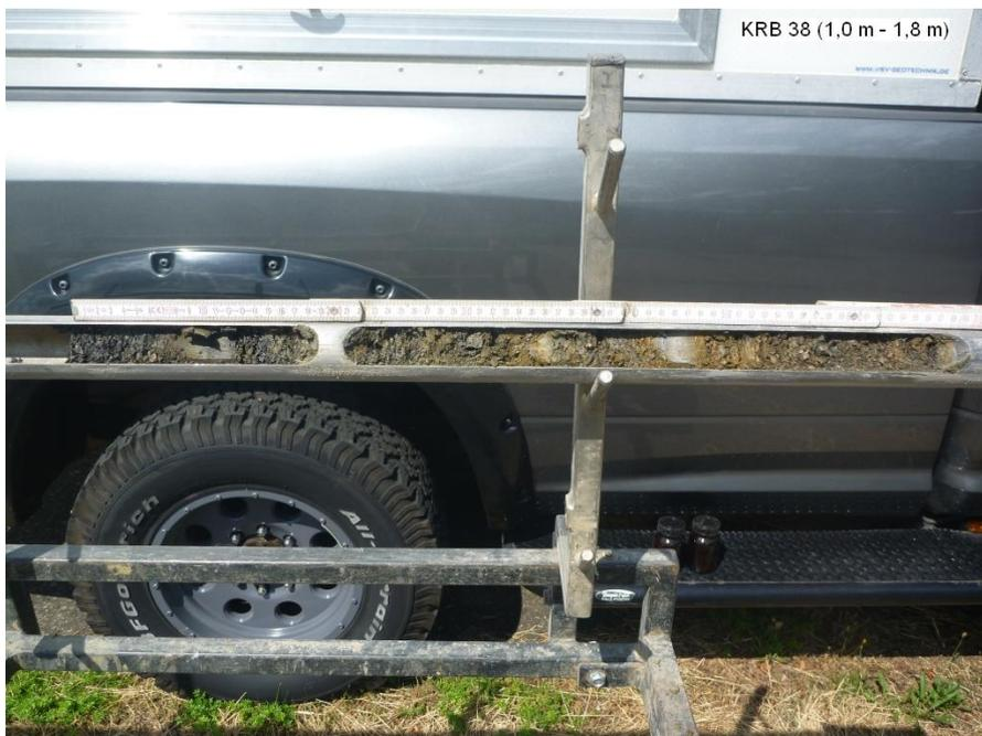
Foto 4: Ansicht des natürlich gelagerten Bodenmaterials (Tonschiefer) der KRB 38 in 1,0 m – 1,8 m unter GOK. (KVF 30)
