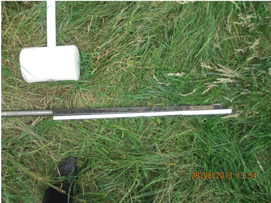
Foto 7: Bohrstocksondierung am Ansatzpunkt g2) im Technischen Bereich Süd
