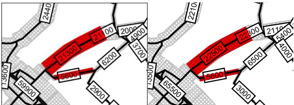
Die Verkehrsbelastung der beiden Straßen wurde dem Masterplan Mobilität entnommen [ 9 ]. Die obigen Ausschnitte mit den Daten des Prognose-0-Falls bzw. des Zielszenarios zeigen für den Kurt-Schumacher-Damm einen maximalen DTV-Wert von 22.500 Kfz/24h und für den Blumenhaller in beiden Fällen 5.600 Kfz/24h.
