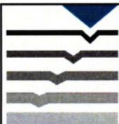
**Zeichnerische Darstellung von Bohrprofilen nach DIN 4023**
