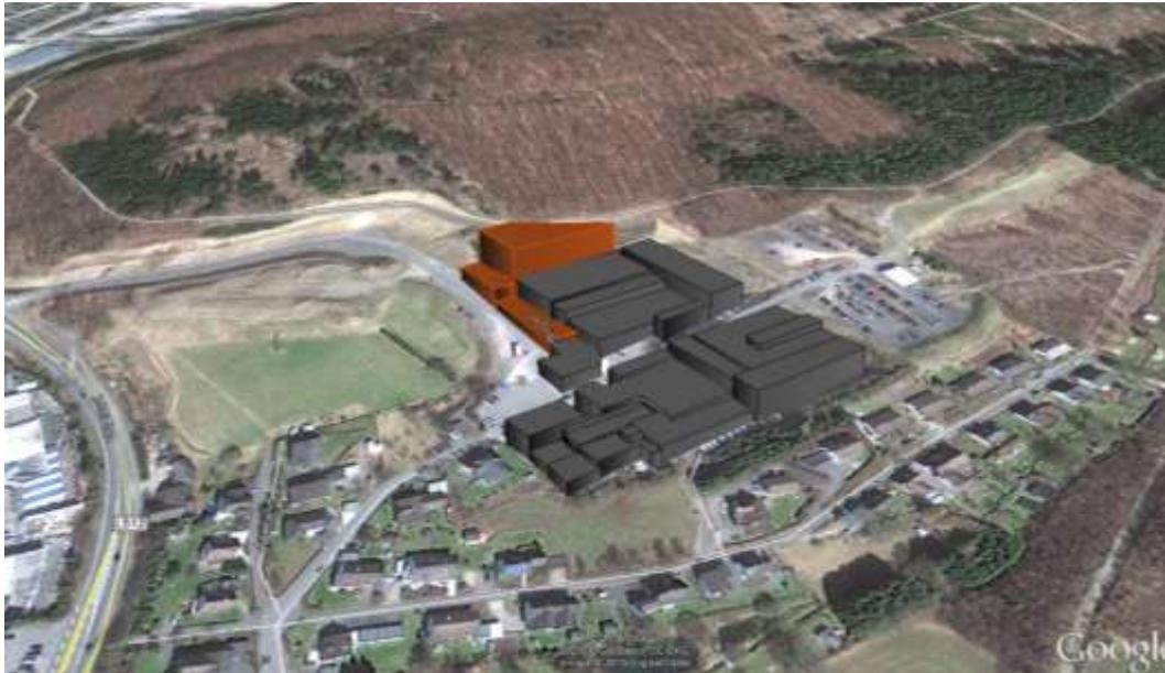
Abbildung 4: 3D-Modell der bei den Ausbreitungsrechnungen berücksichtigten Gebäude für den als 1. Erweiterung vorgesehenen 22 m hohen, nördlich an die bestehende mechanische Bearbeitung angrenzenden Anbau (Grundlage: Google Earth)
