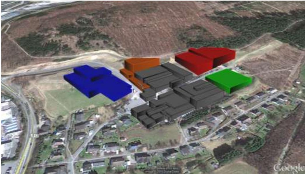
Abbildung 8: 3D-Modell der bei den Ausbreitungsrechnungen berücksichtigten Gebäude einschließlich der optionalen Erweiterung um die neue Putzerei (4. Erweiterung) (Grundlage: Google Earth)
