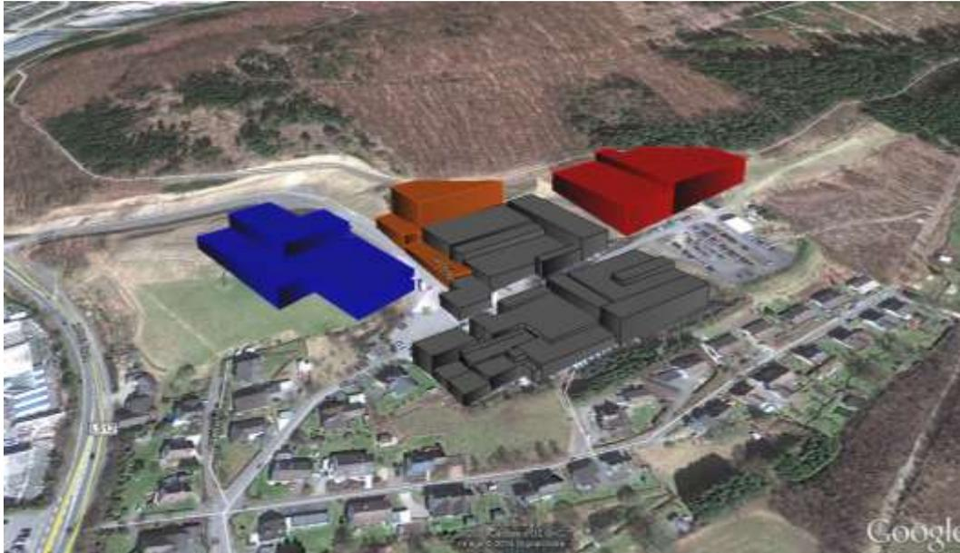
Abbildung 6: 3D-Modell der bei den Ausbreitungsrechnungen berücksichtigten Gebäude einschließlich der optionalen Erweiterung um die neu zu errichtende Halle der Kaltharzgießerei (3. Erweiterung) (Grundlage: Google Earth)
