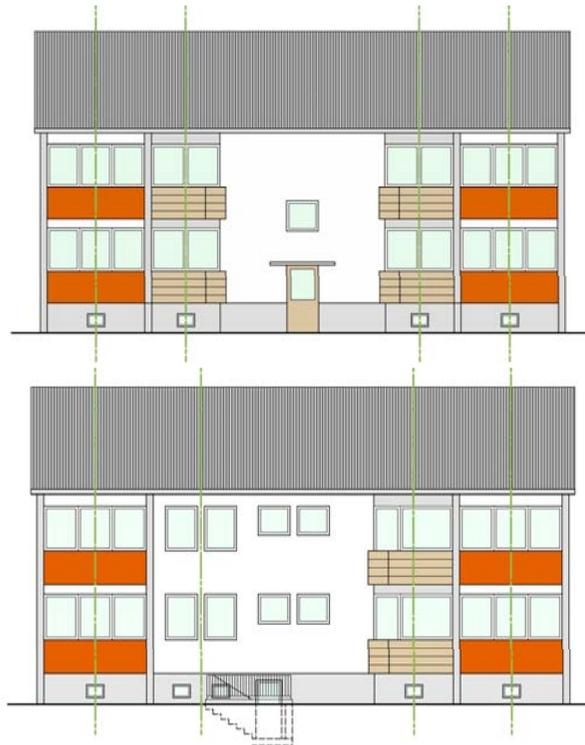
Typ D: Darstellung der Fassaden mit Markierung der für den Dachgeschossausbau bzw. für An- und Vorbauten relevanten Fensterachsen
