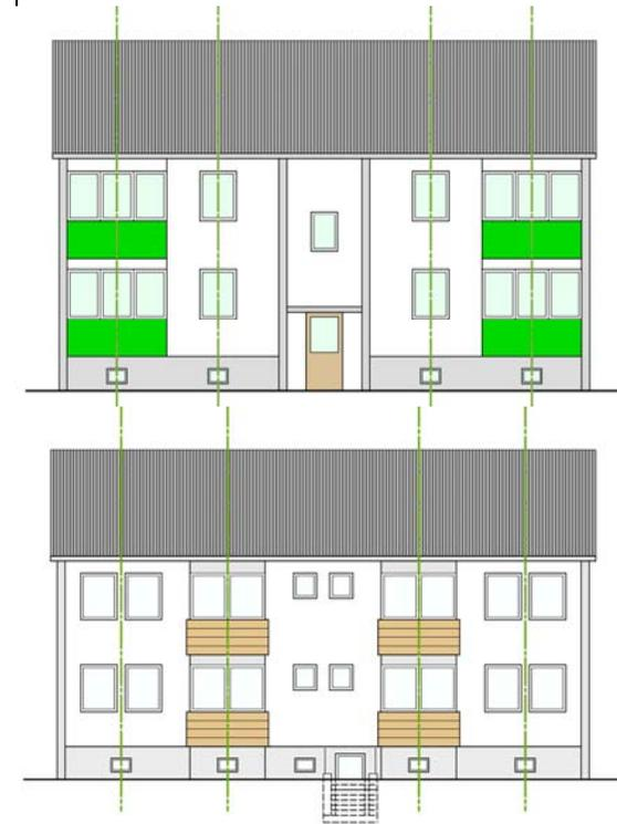
Typ C: Darstellung der Fassaden mit Markierung der für den Dachgeschossausbau bzw. für An- und Vorbauten relevanten Fensterachsen
