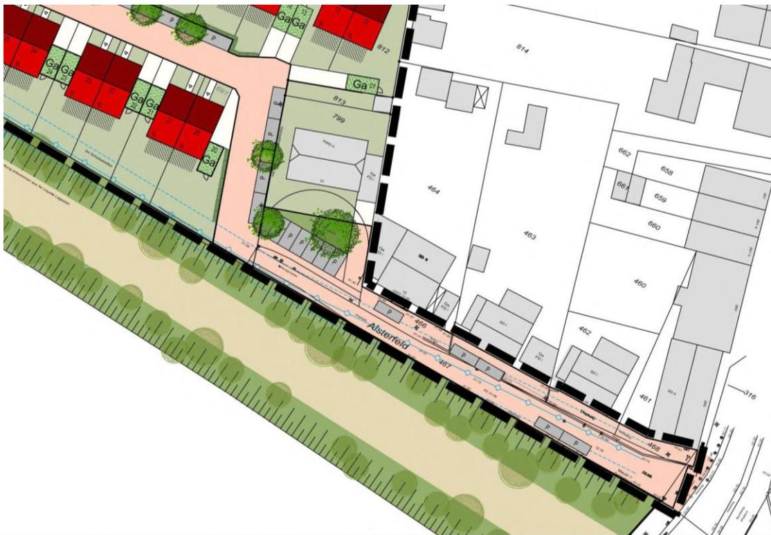
Abb. 7 Straßenausbauvariante 2 mit Erweiterungen und Anpassungen im Verlauf der Straße Alsterfeld
