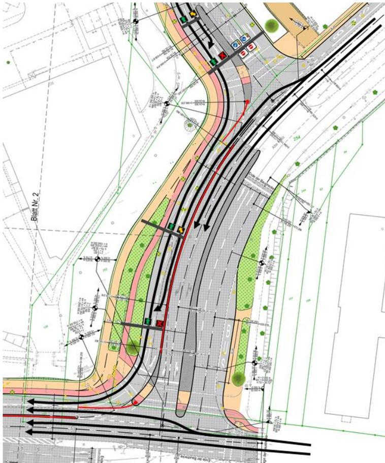
Abbildung 48: Spurführungen im Bereich der separierten Fahrstreifen in der Verkehrsflusssimulation
