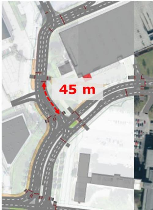
Abbildung 88: Verfügbarer Stauraum Fußgängerschutzanlage südliche Zufahrt
