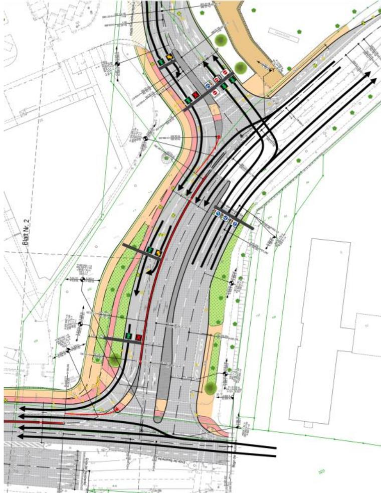
Abbildung 73: Spurführungen im Bereich der separierten Fahrstreifen in der Verkehrsflusssimulation
