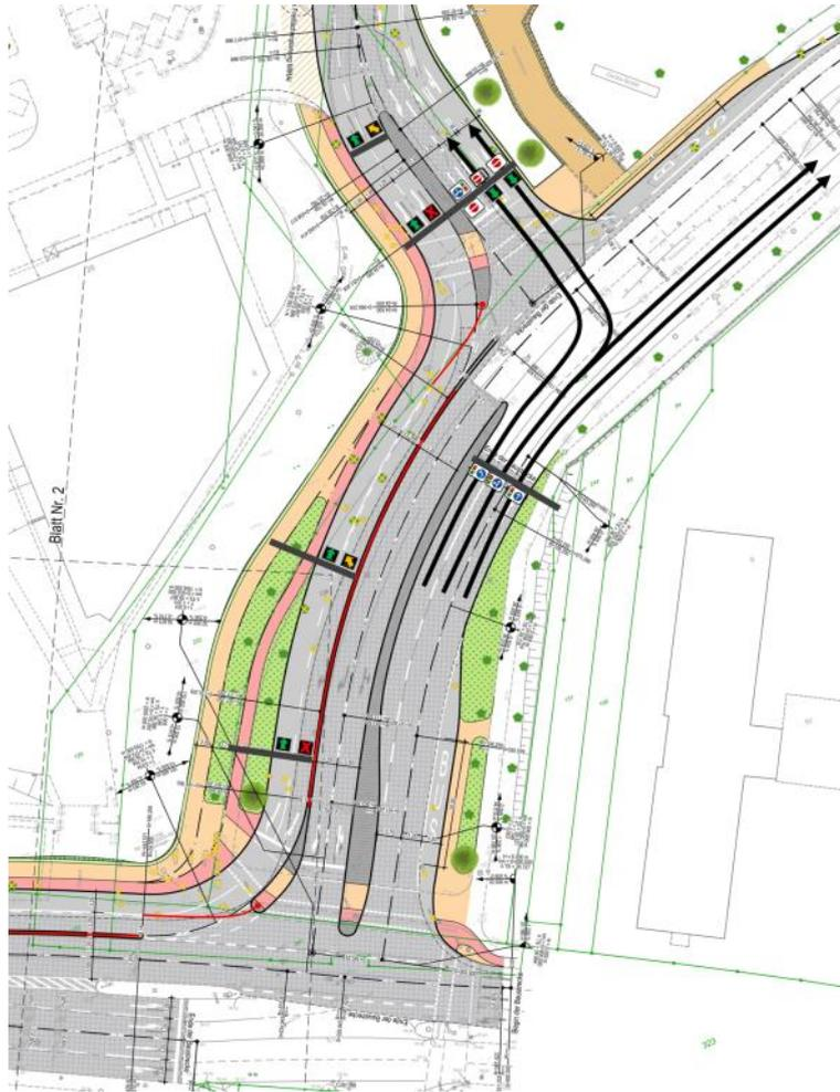
Abbildung 69: Änderung der Verkehrsführung am Knotenpunkt A154
