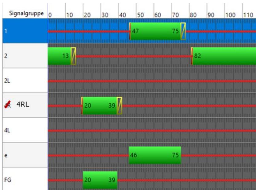
Abbildung 133: Signalprogramm A154 (Alte Walz / Planstraße X) Spitzenbelastung PPF P10 Ausbauvariante 2
