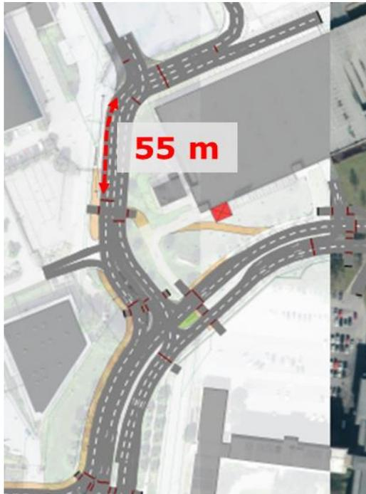
Abbildung 90: Verfügbarer Stauraum Fußgängerschutzanlage nördliche Zufahrt
