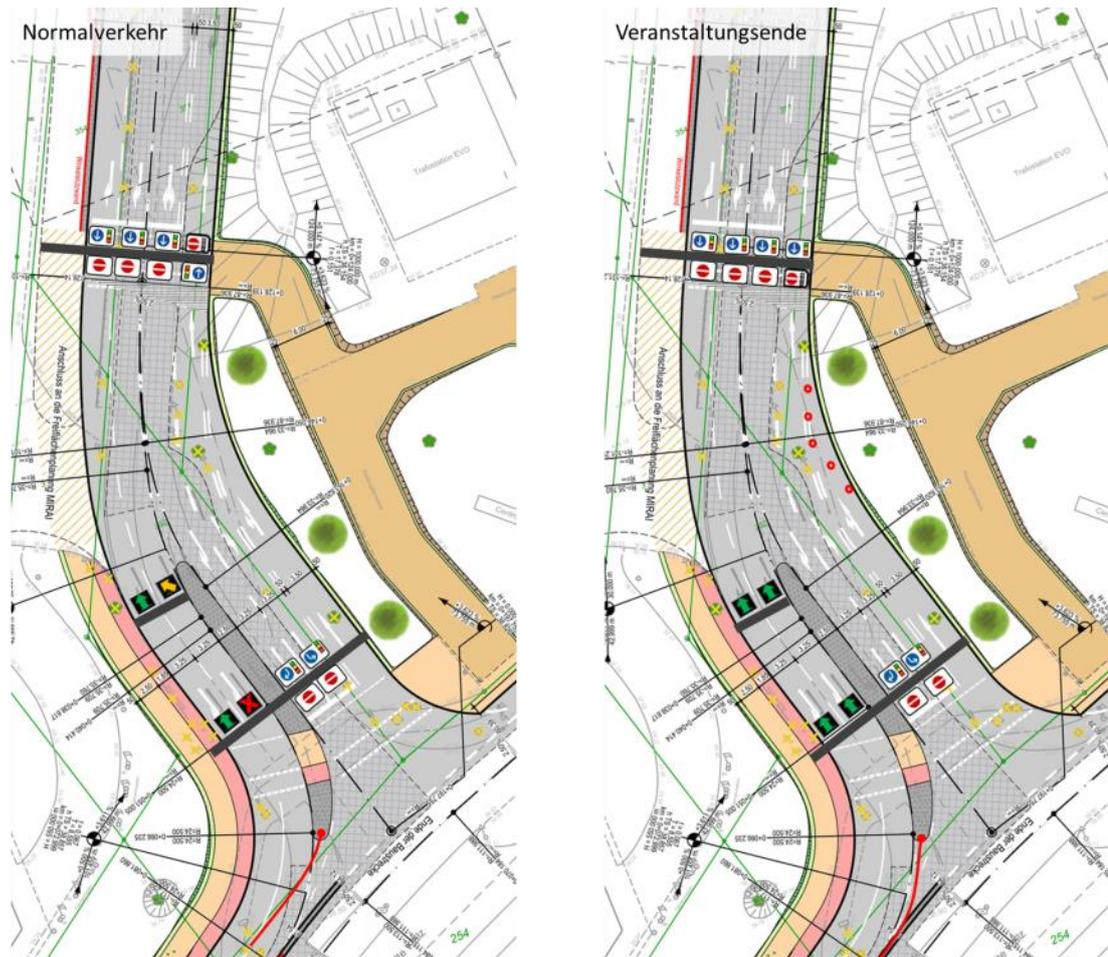
Abbildung 45: Beispiel dynamische Fahrstreifensignalisierung im Bereich der Planstraße X
