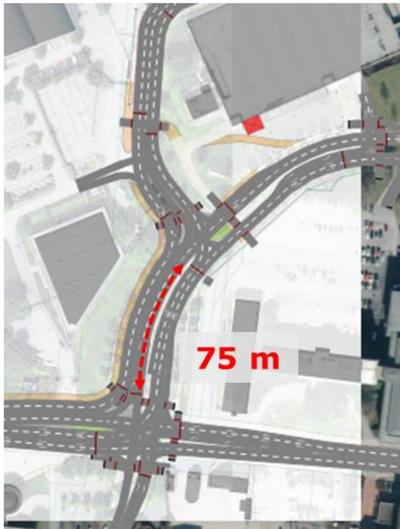
Abbildung 78: Verfügbarer Stauraum A141 4GL (Mischfahrstreifen Alte Walz FR Süd)
