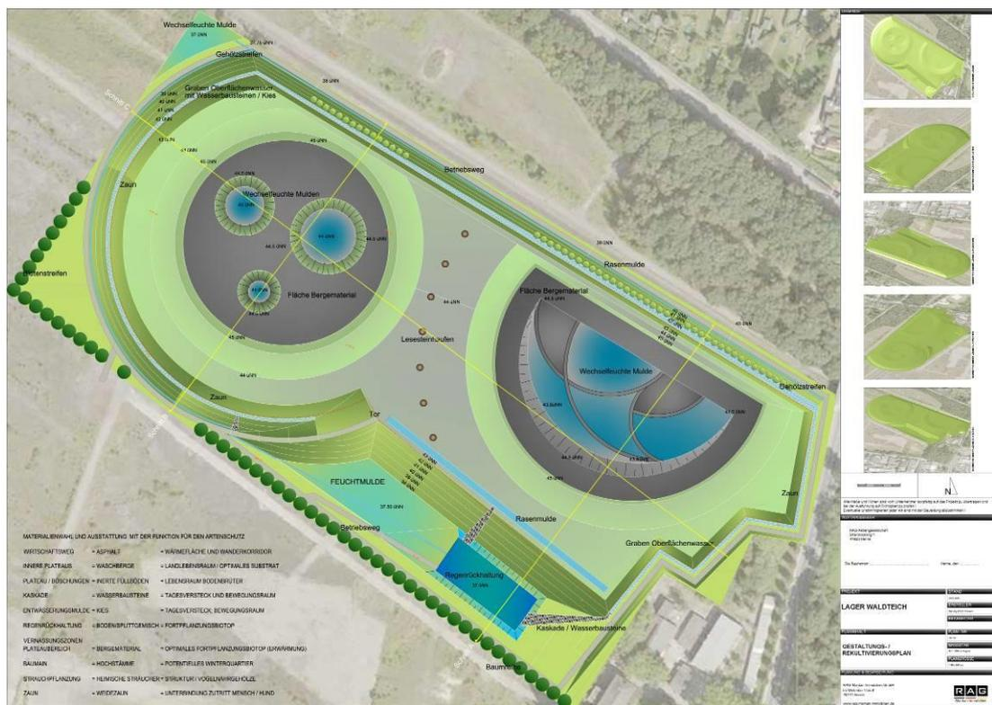
Abb. 16: Gestaltungs- u. Rekultivierungsplan für das Sicherungsbauwerk (RAG MONTAN IMMOB.)
