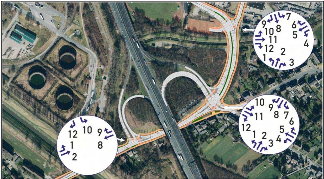
Abbildung 14: Darstellung der ausgewerteten Ströme (Quelle des Hintergrundluftbilds: Land NRW (2017))
