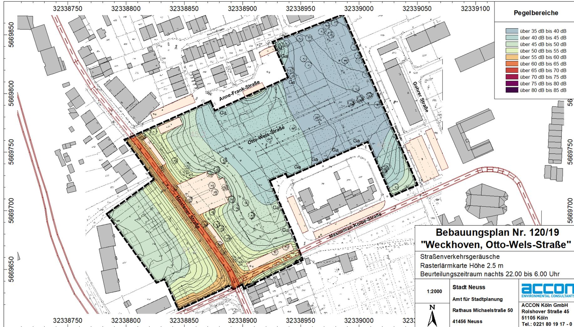
**Abb. 4.2.6** Geräuschsituation innerhalb des Plangebiets nachts in Form einer Lärmkarte für die freie Schallausbreitung in einer Höhe von 2,5 m (EG)
