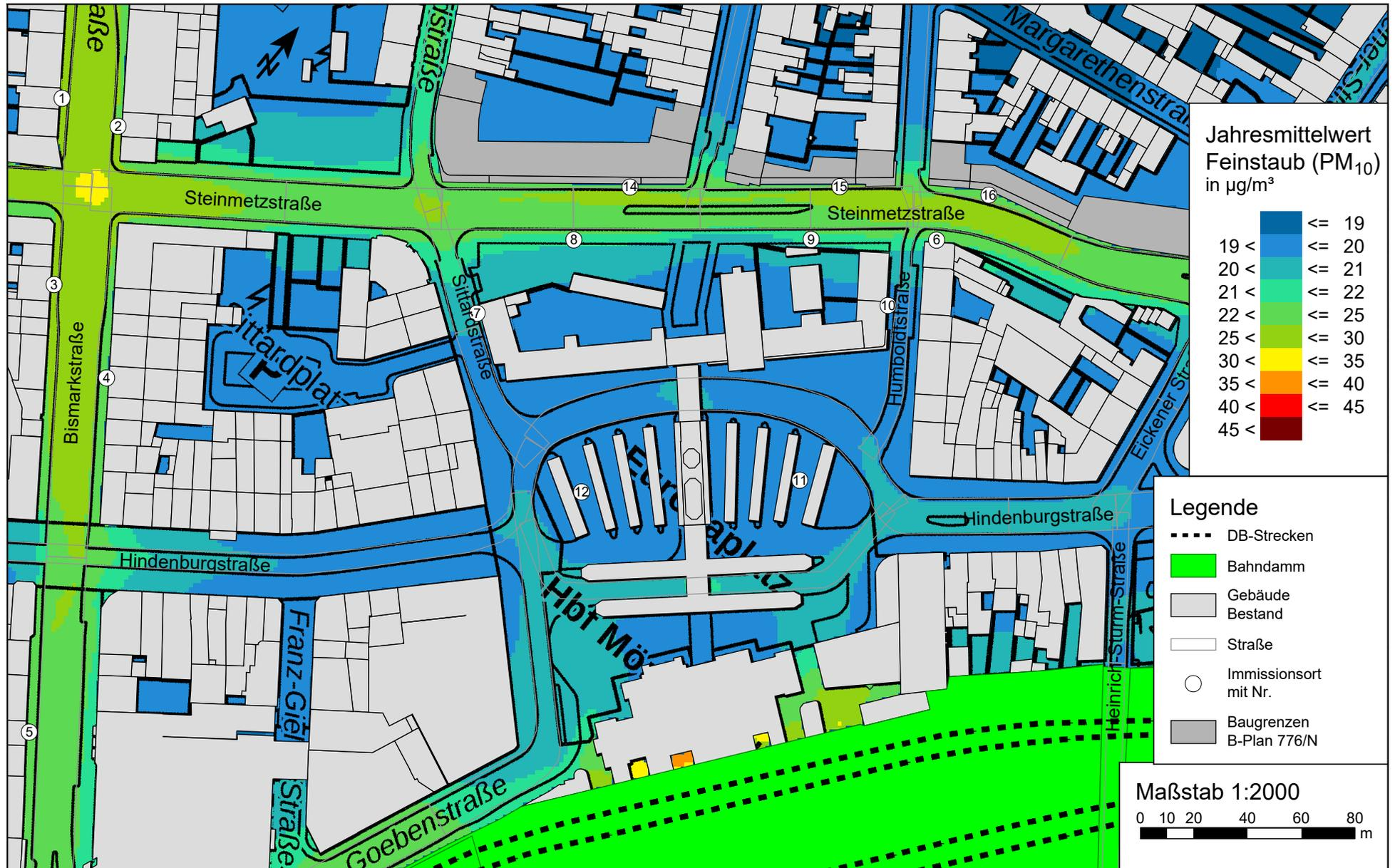
Feinstaub (PM<sub>10</sub>) Gesamtbelastung (Jahresmittelwert, h = 1,5 m) für den "Planfall 2024" zum Bebauungsauungsplan Nr. 789/N in Mönchengladbach mit einer Hintergrundbelastung von 18,7 µg/m<sup>3</sup>; Grenzwert 39. BImSchV: 40,0 µg/m<sup>3</sup>
