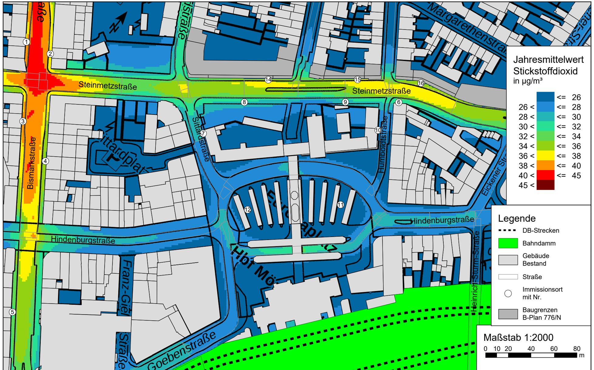
Stickstoffdioxid (NO<sub>2</sub>) Gesamtbelastung (Jahresmittelwert, h = 1,5 m) für den "Planfall 2024" zum Bebauungsaußensplan Nr. 789/N in Mönchengladbach mit einer Hintergrundbelastung von 22,3 µg/m<sup>3</sup>; Grenzwert 39. BImSchV: 40,0 µg/m<sup>3</sup>
