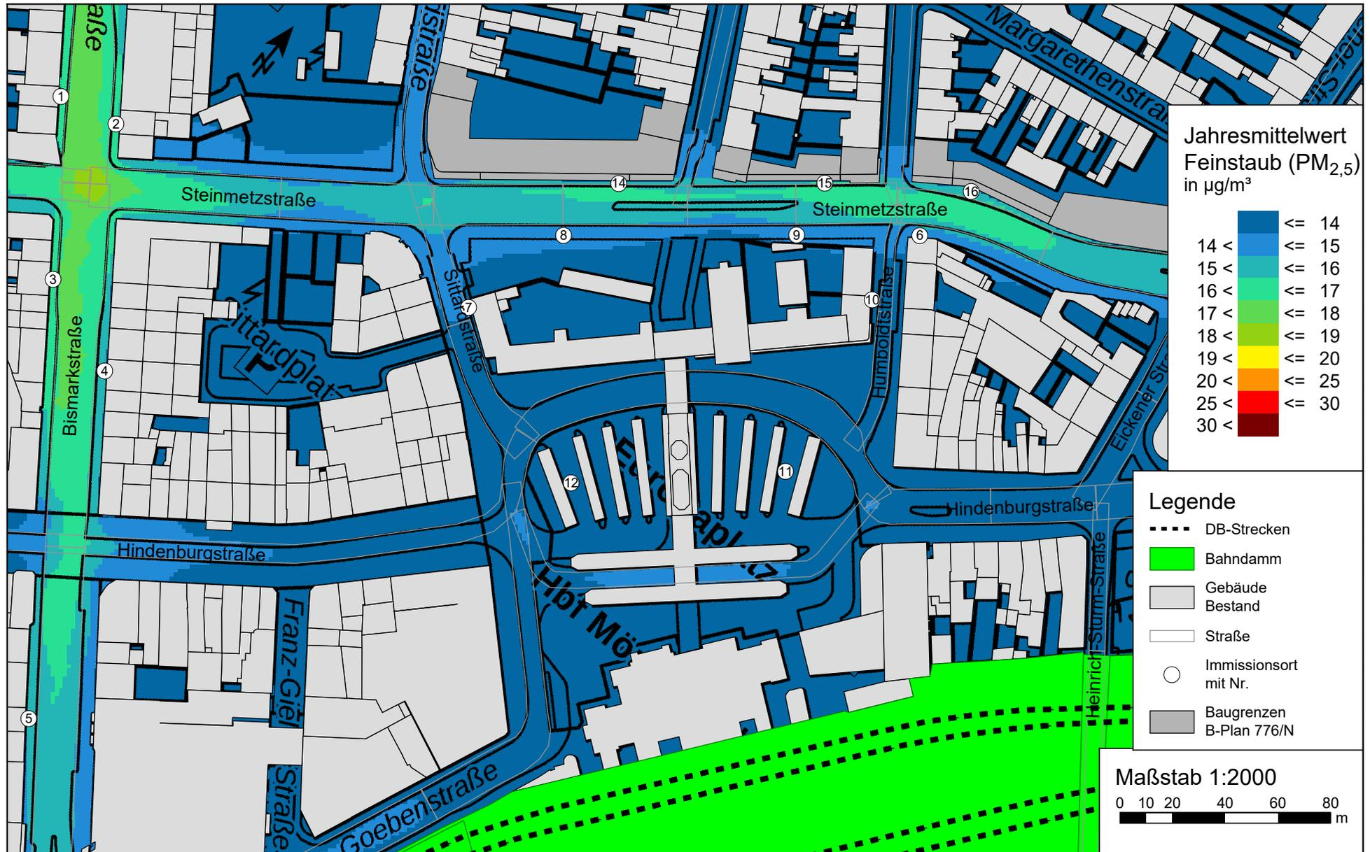
Feinstaub (PM<sub>2,5</sub>) Gesamtbelastung (Jahresmittelwert, h = 1,5 m) für den "Planfall 2024" zum Bebauungsauflagenplan Nr. 789/N in Mönchengladbach mit einer Hintergrundbelastung von 13,0 µg/m<sup>3</sup>; Grenzwert BImSchV: 25,0 µg/m<sup>3</sup>
