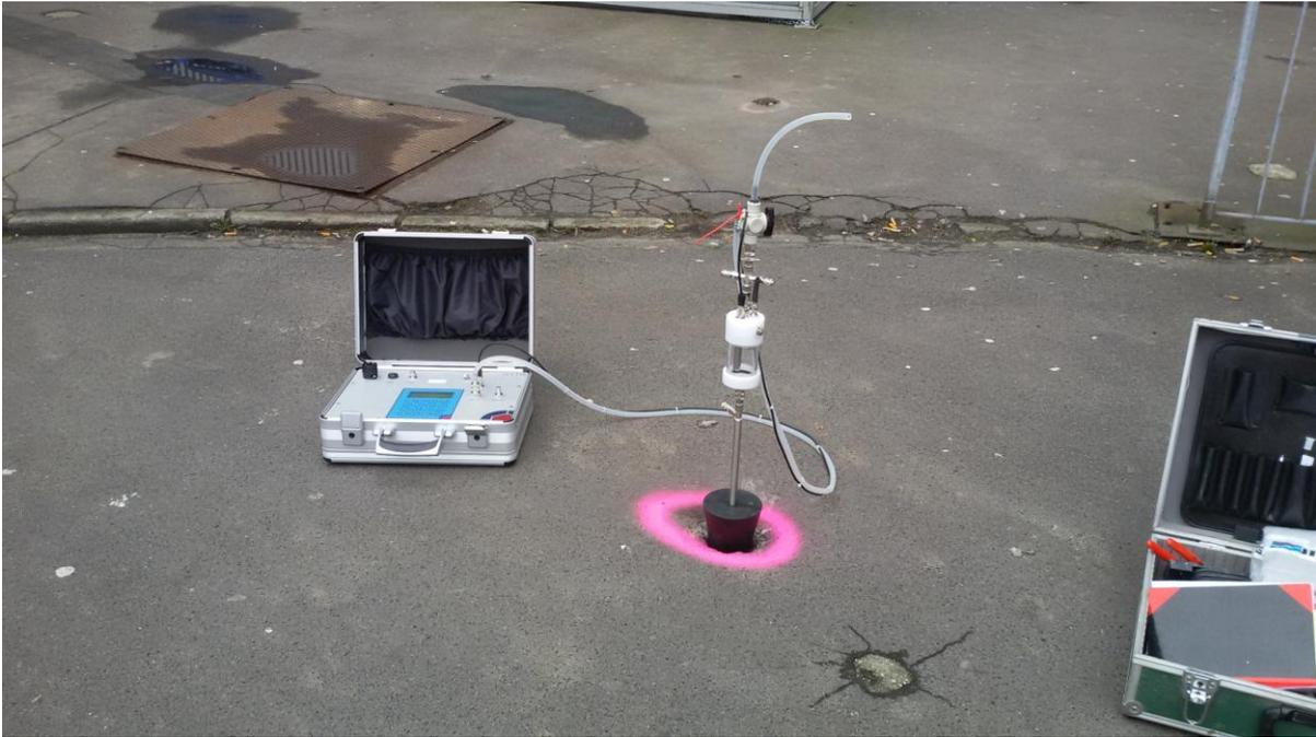
Abb. 2: Bodenluftprobenahmesystem G 110 Honold, ohne Aktivkohleröhrchen
