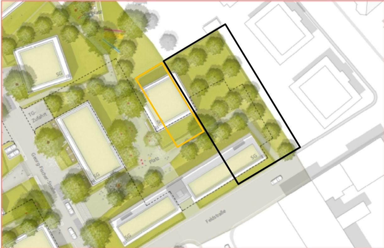
**Abb. 3: Projekt Lindenpark, Ausschnitt aus einem Lageplan mit Kennzeichnung der Altlastenverdachtsfläche [6]**
